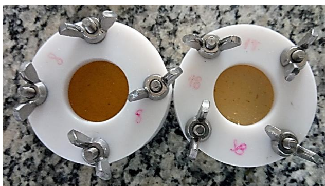
Figura 10 Detalhe do posicionamento das amostras nas células de permeação.
