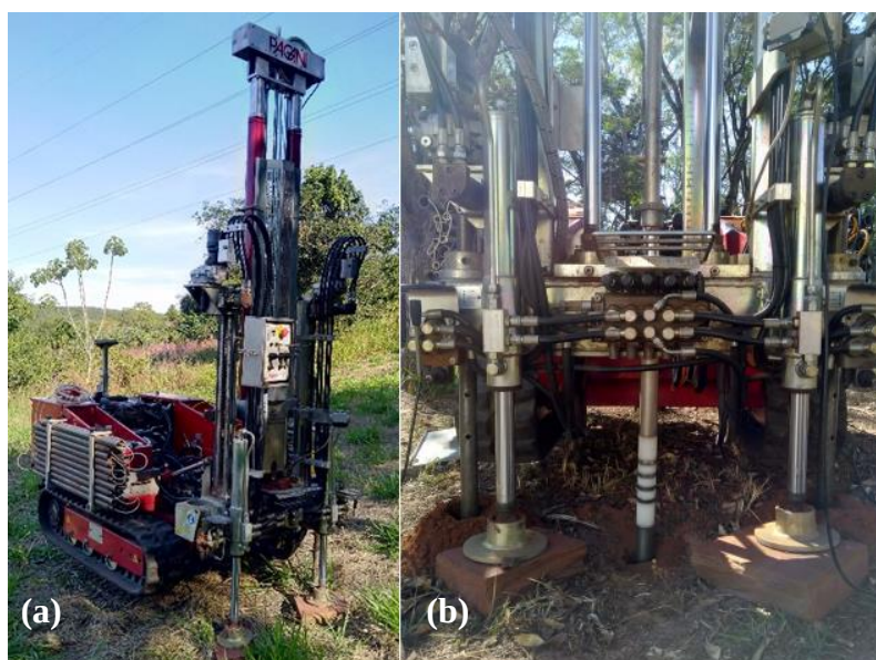
Figura 53. (a) Equipamento de penetração; (b) detalhe da sonda no equipamento.
