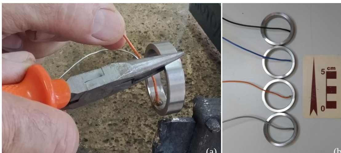
Figura 33. (a) Detalhe da solda dos eletrodos; (b) detalhe dos eletrodos com cabos elétricos.
