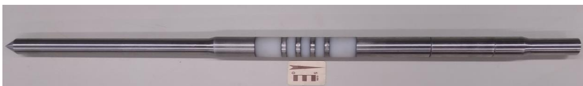
Figura 37. Sonda desenvolvida para leitura da resistividade elétrica.
