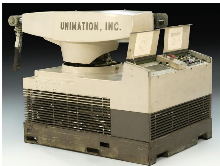
Figura 1: Unimate: o primeiro robô desenvolvido para a indústria
