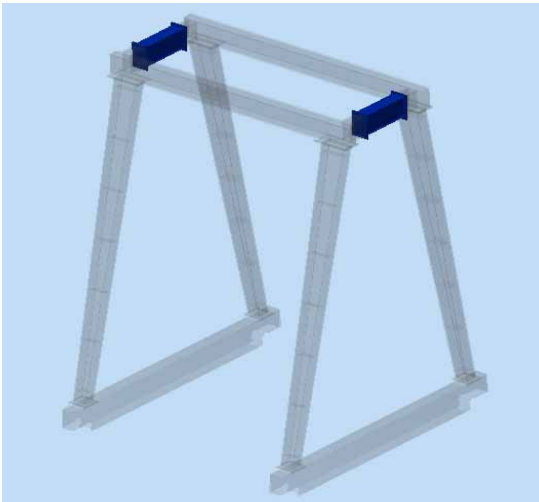
Figura 13 – Viga de fechamento.
