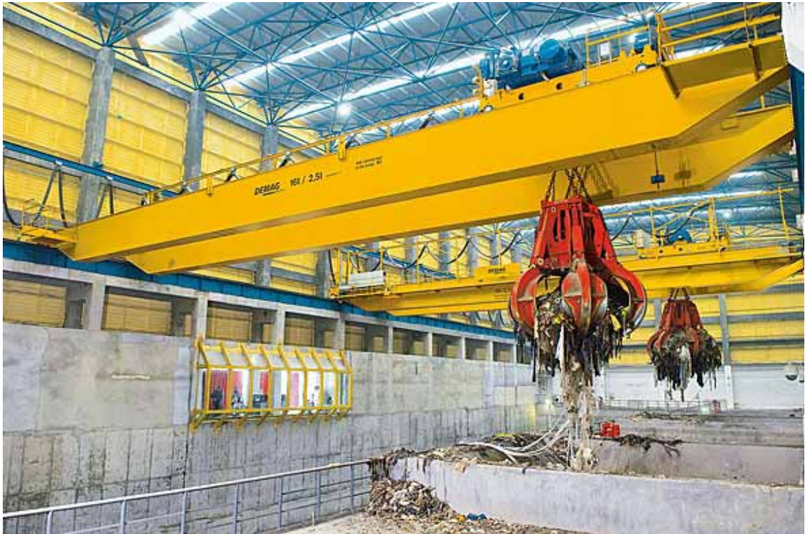
Figura 8 – Ponte rolante tipo dupla viga.
