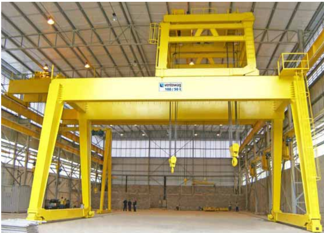
Figura 10 – Pórtico rolante tipo dupla viga.
