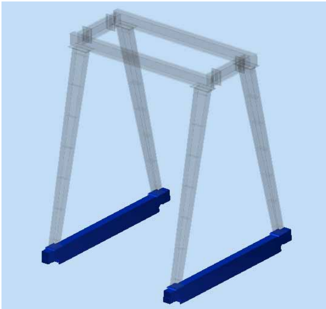
Figura 15 – Vigas de ligação.
