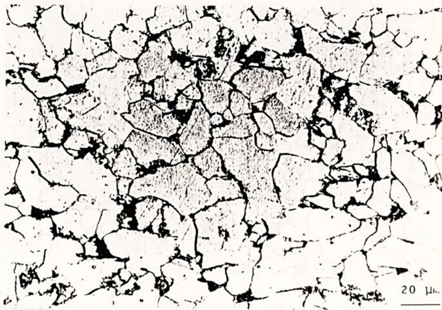
Figura 4.5 - Microestrutura bifásica obtida pelo tratamento térmico TM, atacada com nital 2%, nucleadas a partir da microestrutura apresentada na figura 4.4.
