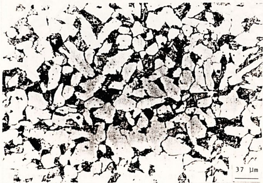
Figura 4.25 - Microestrutura TD, após 20000 ciclos sob tensão de 310 MPa. Ausência de bandas de deslizamento.
