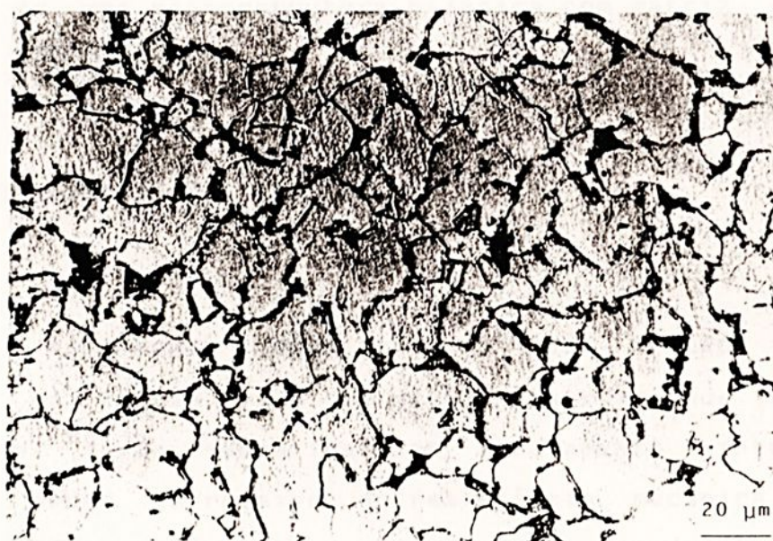
Figura 4.7 - Microestrutura bifásica obtida pelo tratamento térmico TR, atacada com nital 2%, apresentando tendência de formação de matriz martensítica contínua.
