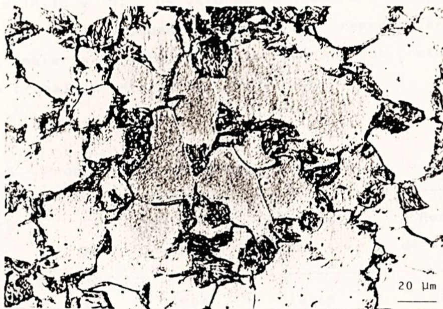
Figura 4.8 - Microestrutura bifásica obtida pelo tratamento térmico TDR, atacada com nital 2%, nucleada a partir de uma microestrutura bifásica com matriz ferrítica contínua.
