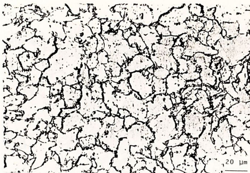
Figura 4.6 - Microestrutura obtida por têmpera convencional em água gelada a partir de 950° C , e revenida por 2 horas a 700° C, atacada com nital 2%, apresentando formação de partículas esferoidizadas.
