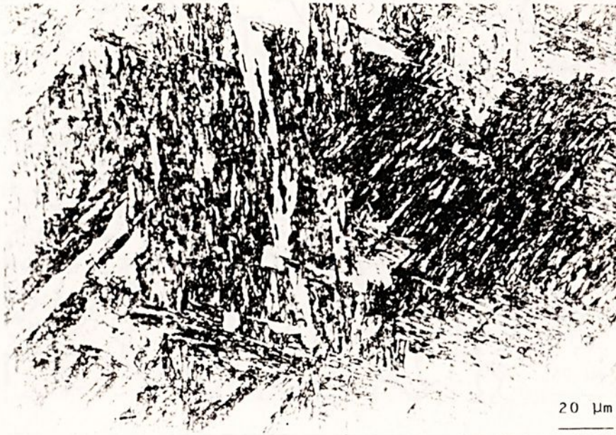
Figura 4.4 - Microestrutura obtida por têmpera convencional em água gelada a partir de 950° C , atacada com nital 2%, apresentando uma estrutura martensítica.
