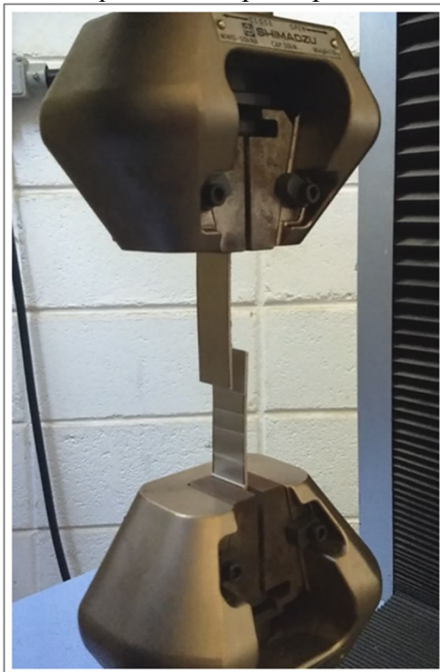
Figura 54: Corpo de prova do Lap-shear rompido após a realização do ensaio mecânico
