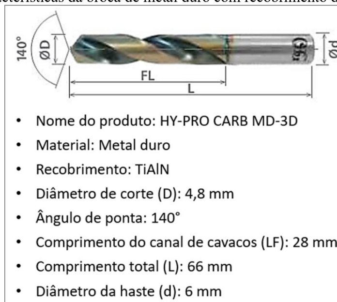
Figura 38: Características da broca de metal duro com recobrimento de TiAlN da OSG
