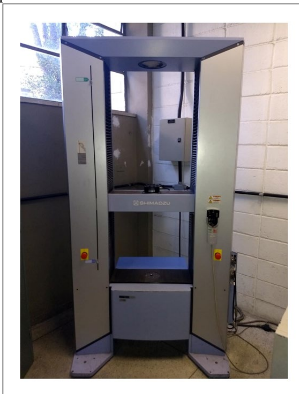
Figura 30: Máquina universal de ensaios mecânicos Shimadzu, modelo AG-X
