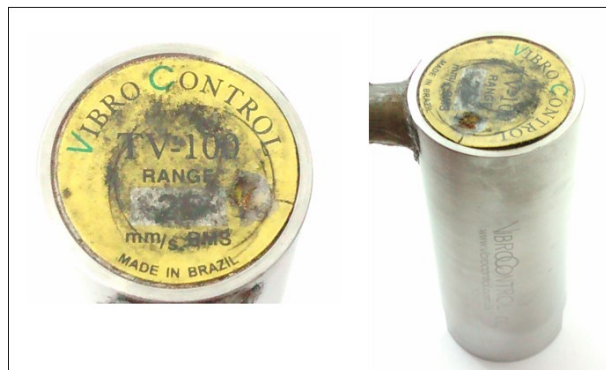
Figura 41- Sensor piezelétrico, marca VibroControl, modelo TV100
