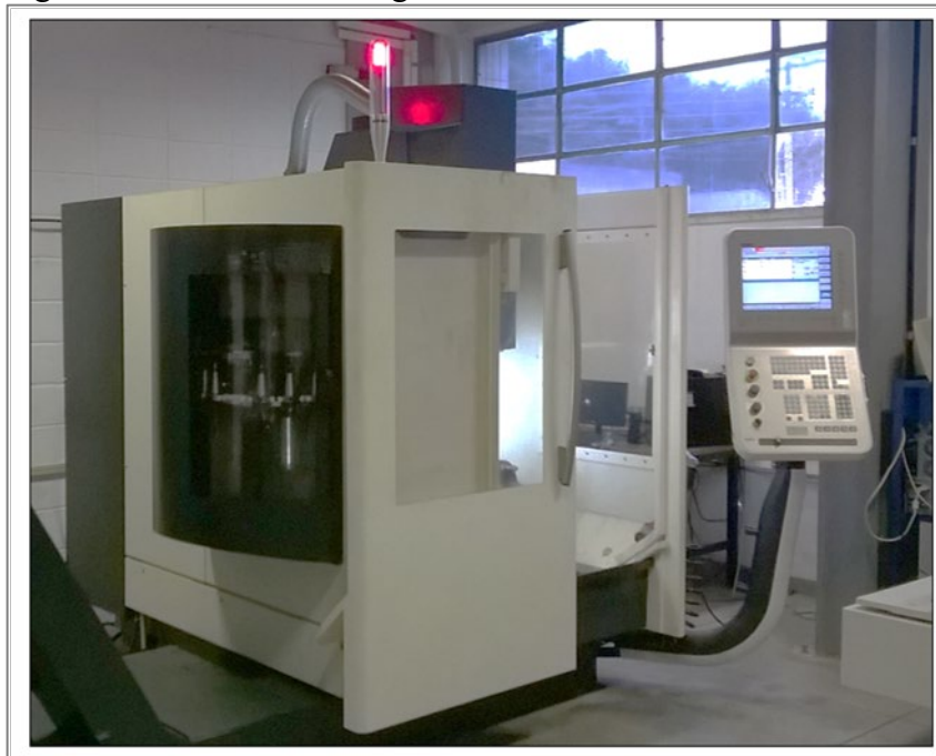
Figura 35: Centro de Usinagem marca DMG modelo DMU50ECO
