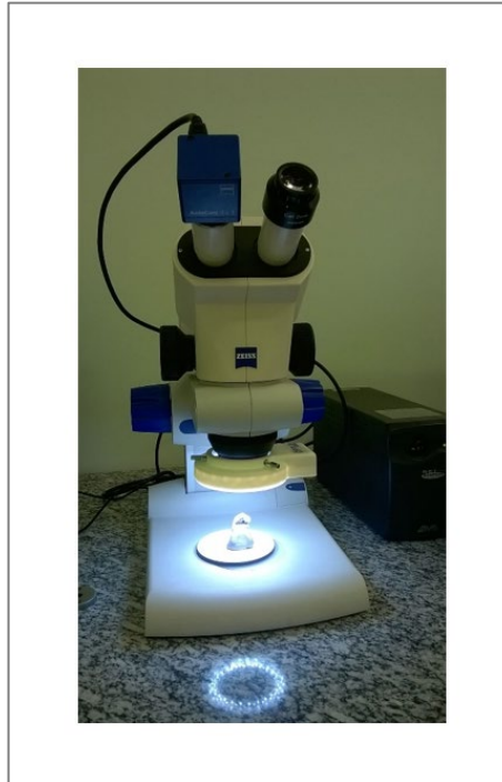
Figura 43: Lupa da Zeiss, modelo Stemi 2000
