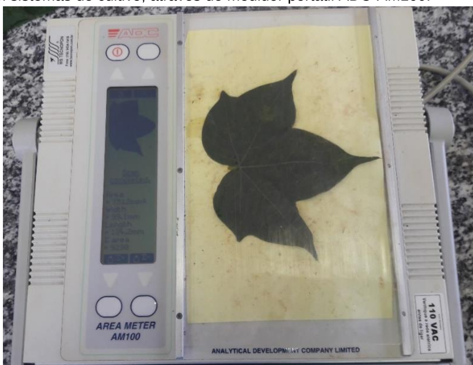
Figura 2- Medição da área foliar do algodoeiro herbáceo em função de doses e fontes de N em sistemas de cultivo, através do medidor portátil ADC-AM100.
