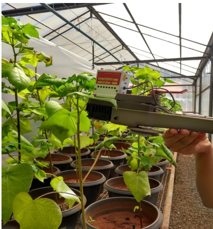
Figura 31- Avaliação de trocas gasosas em algodoeiro herbáceo com o equipamento portátil (Infra Red Gas Analyser –IRGA). Ilha Solteira- SP, 2019.
