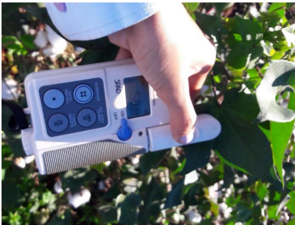
Figura 5- Medição do índice SPAD no algodoeiro herbáceo em função de doses e fontes de N em sistemas de cultivo. Selvíria-MS, 2017/18.
