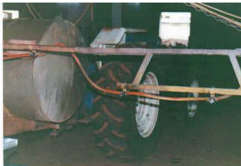
Figura 7. Erros no espaçamento e altura dos bicos.
