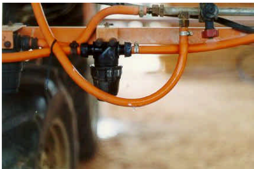
Figura 6. Mangueira interferindo na projeção do jato.
