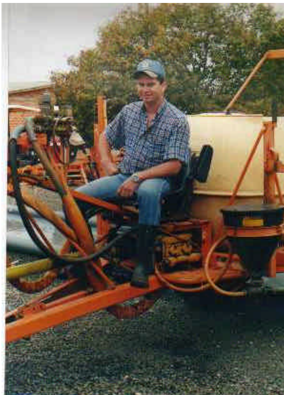
Figura 12. Adaptação de assento no pulverizador.
