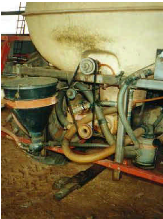
Figura 11. Parte móvel do pulverizador sem proteção.
