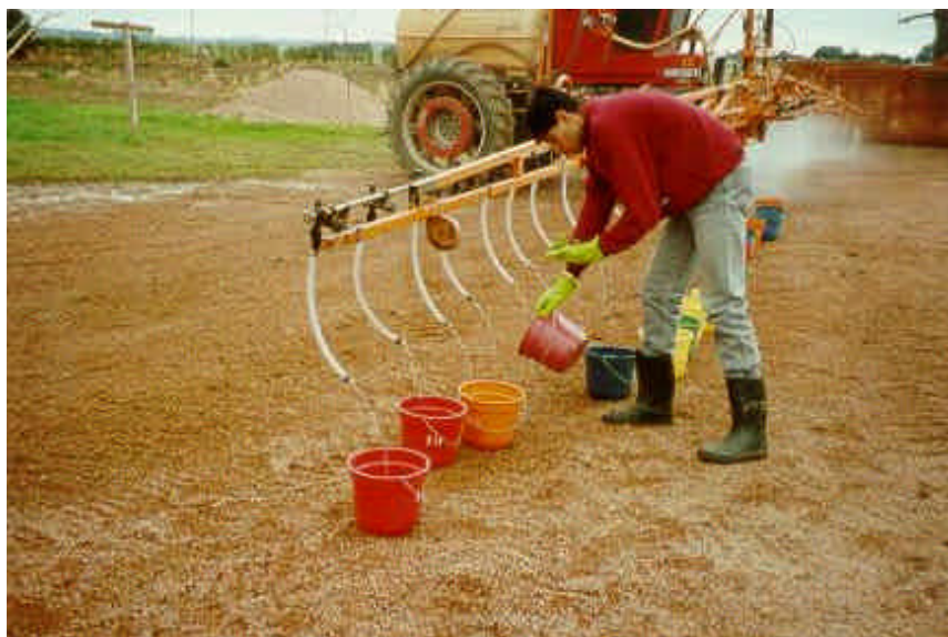
Figura 8. Avaliação da vazão das pontas de um pulverizador.
