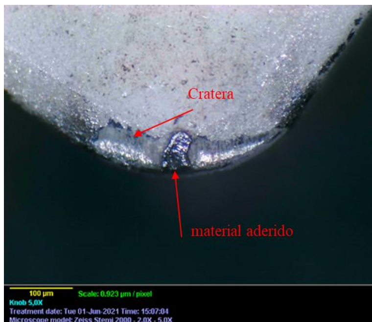
Figura 106 – Desgaste de cratera da ferramenta para combinação (350-0,05-0,50).
