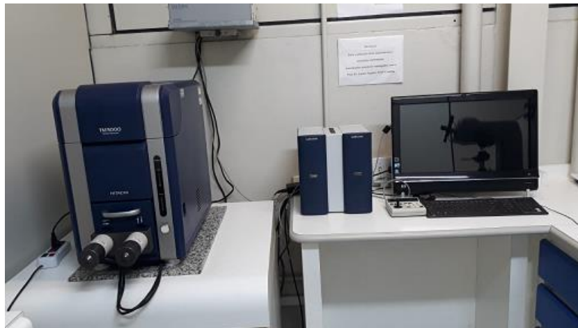
Figura 47 – Microscópio eletrônico de varredura (MEV) modelo TM3000, da marca Hitachi.
