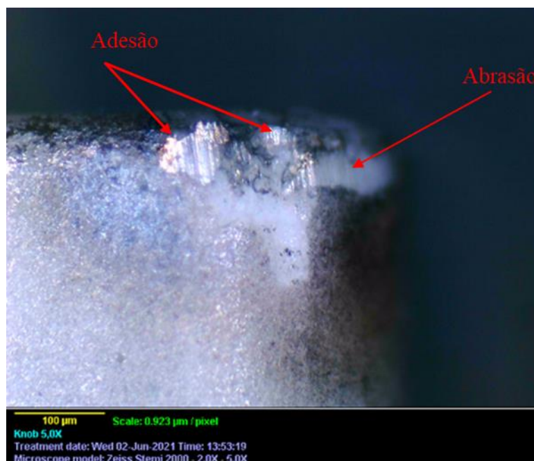
Figura 119 – Desgaste de abrasão e adesão para ensaio de vida 2 (200-0,10-0,50).
