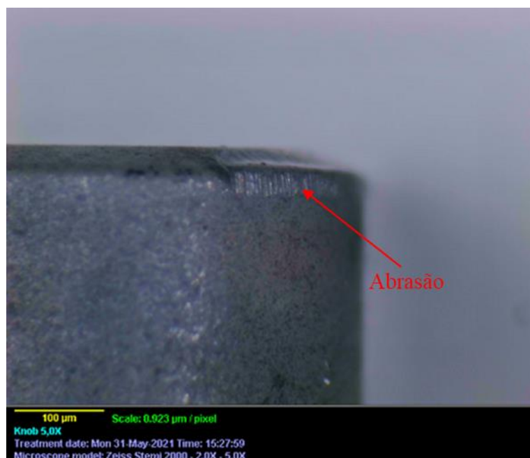
Figura 99 – Desgaste por abrasão da ferramenta para combinação (225-0,10-0,50).
