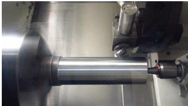
Figura 8 – Processo de torneamento.
