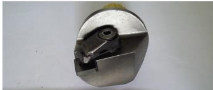
Figura 38 – Suporte capto da marca Seco Tools, modelo B01T9032445.
