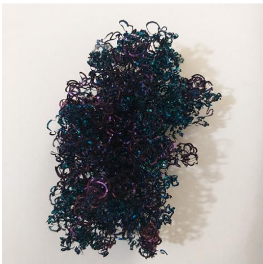
Figura 101 – Cavacos para combinação (225-0,10-0,50).
