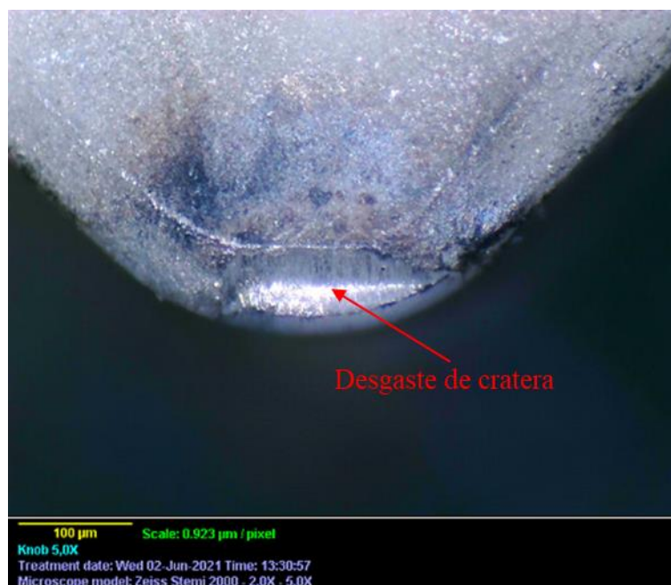
Figura 116 – Desgaste de cratera para o ensaio de vida 1 (225-0,05-0,25).
