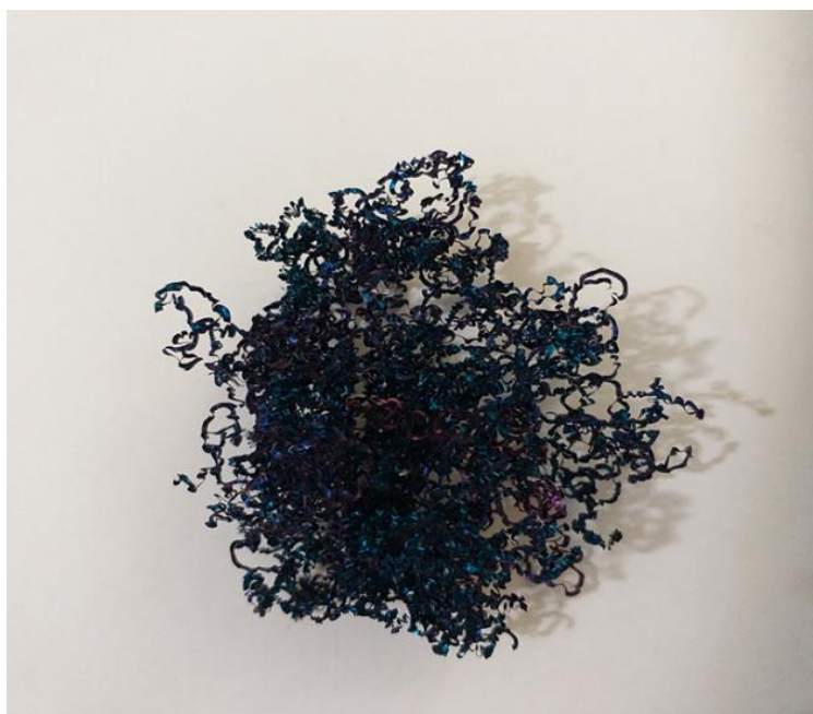
Figura 98 – Cavacos para combinação (200-0,05-0,25).
