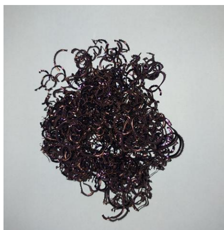
Figura 104 – Cavacos para combinação (300-0,05-0,50).
