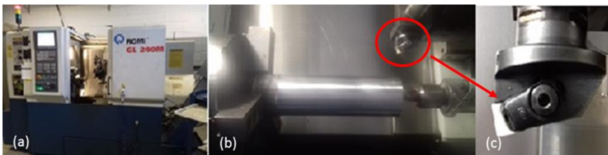
Figura 40 – (a) Centro de torneamento, (b) Material de trabalho (c) ferramenta de corte.
