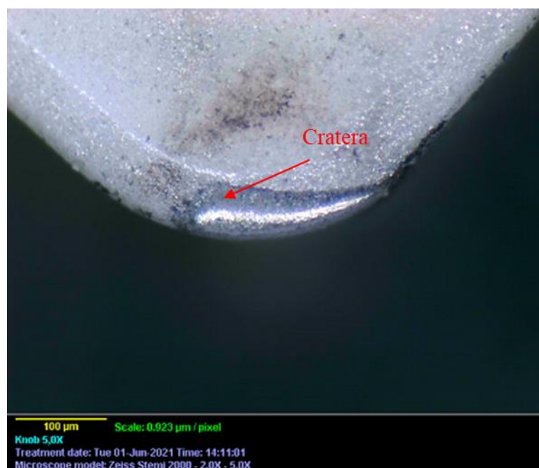
Figura 100 – Desgaste de cratera da ferramenta para combinação (225-0,10-0,50).
