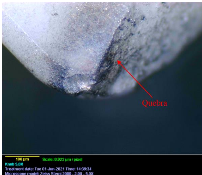
Figura 109 – Detalhes da quebra da ferramenta para combinação (275-0,10-0,50).
