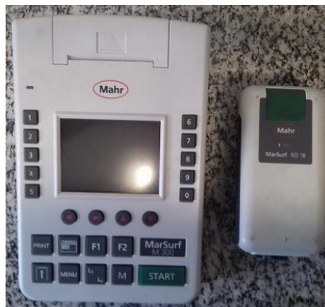
Figura 44 – Rugosímetro Mahr modelo MarSurf M300/MahrSurf RD 18.
