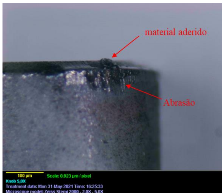
Figura 105 – Desgaste por abrasão da ferramenta para combinação (350-0,05-0,50).
