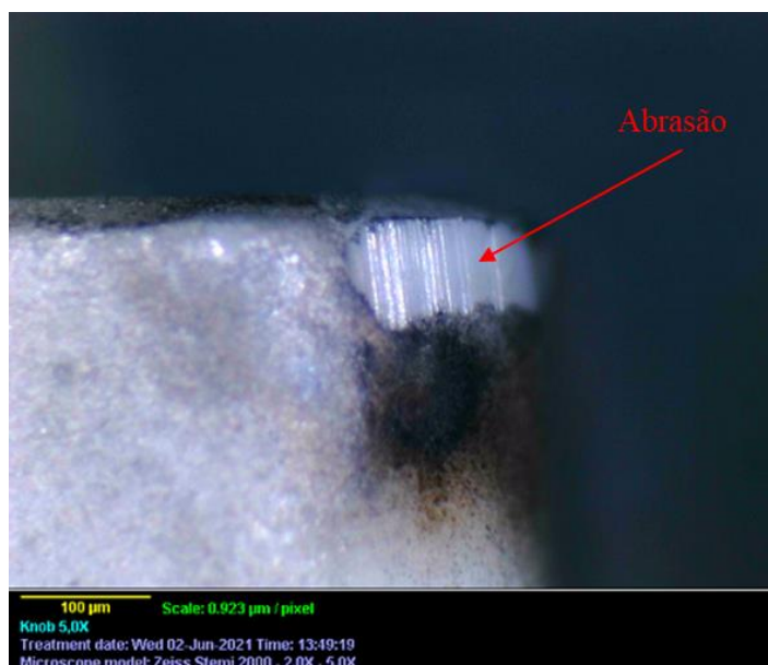
Figura 115 – Desgaste de abrasão para o ensaio de vida 1 (225-0,05-0,25).
