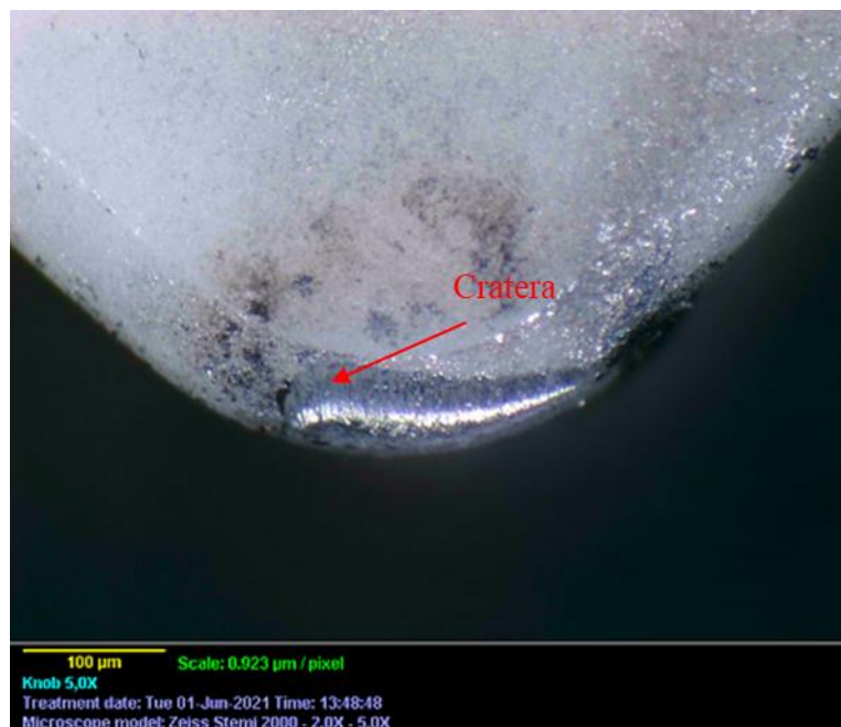
Figura 97 – Desgaste de cratera da ferramenta para combinação (200-0,05-0,25).
