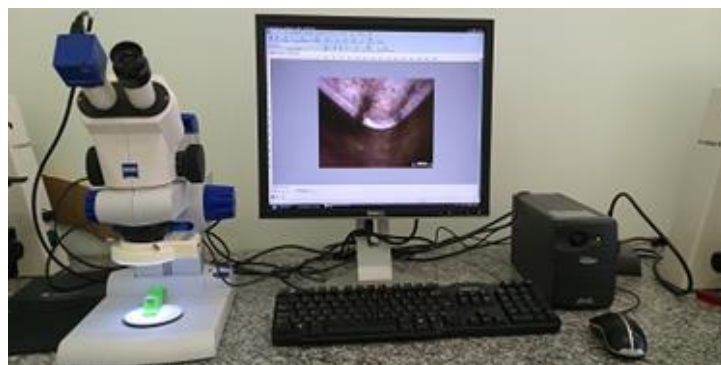
Figura 46 – Microscópio Stereo da marca Zeiss, modelo Stemi 2000.
