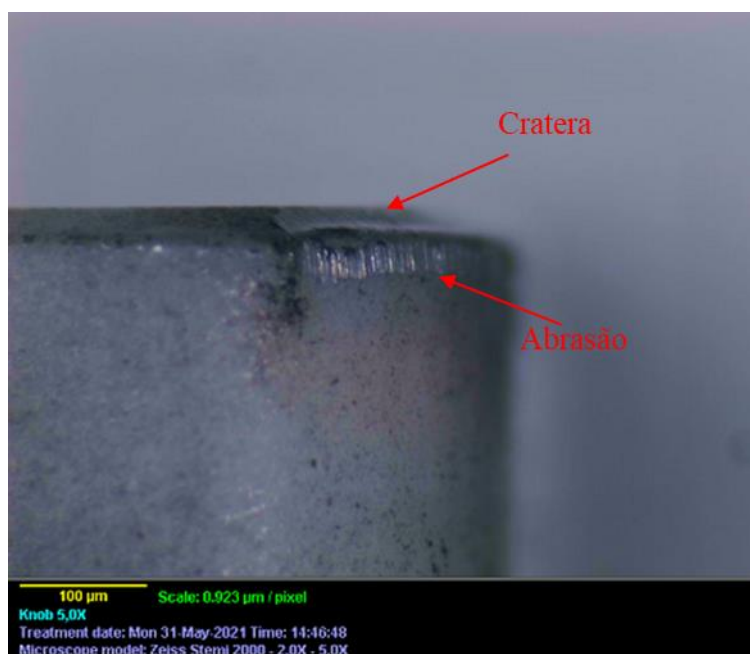
Figura 96 – Desgaste por abrasão da ferramenta para combinação (200-0,05-0,25).
