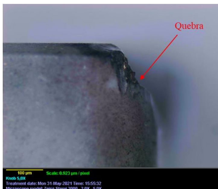
Figura 108 – Quebra da ferramenta para combinação (275-0,10-0,50).
