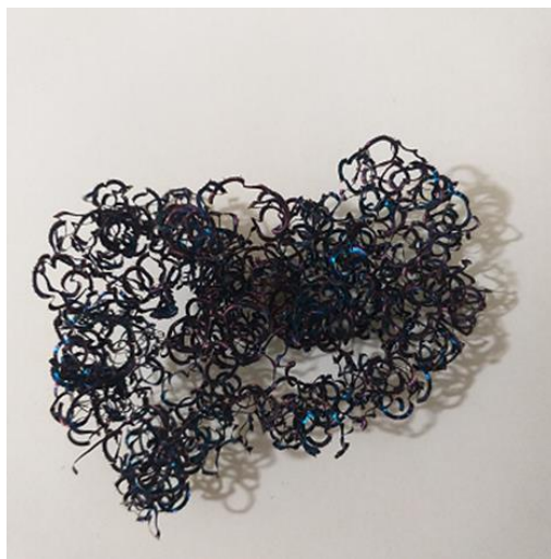
Figura 107 – Cavacos para combinação (350-0,05-0,50).
