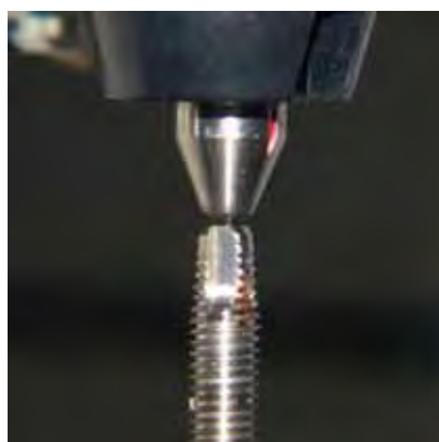
FIGURA 8 – Ensaio de dureza na base do implante.
