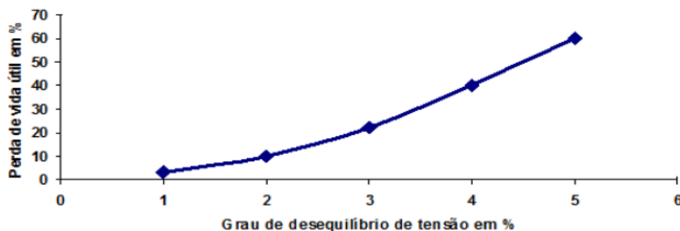
Figura 7 – Perda da vida útil do motor em razão do desequilíbrio
