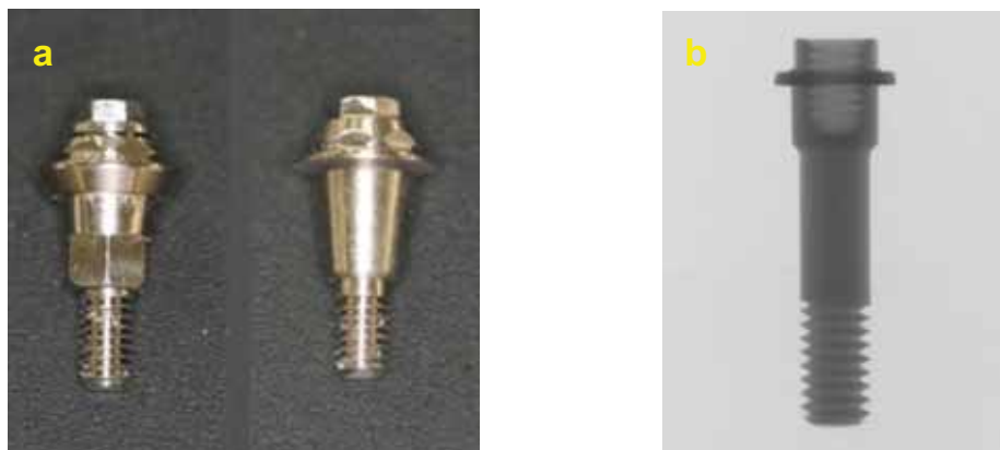
Figura 9 - a) Componentes protéticos (à esquerda Pilar Hexagonado e à direita Pilar Sólido); b) Imagem do Parafuso Passante em TIFF (corte nº 255 da microtomografia).
