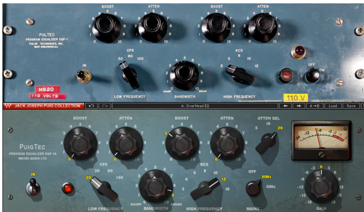
Figura 15 – Comparação das versão reais e virtual do equalizador EQP-1A.
