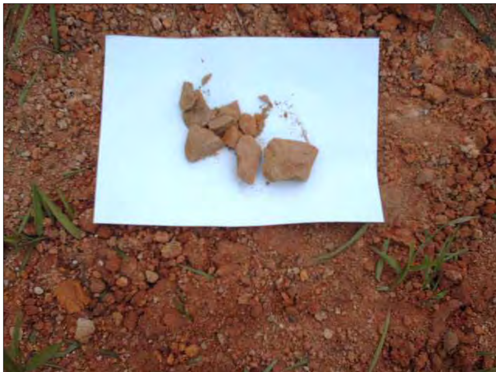
Figura 8. Detalhe de fragmentos de arenito fino retirado no ponto de sondagem SP-15.
