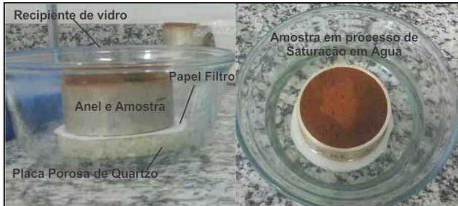
Figura 14 – Saturação da amostra de solo com água
