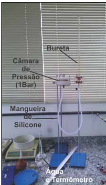
Figura 16- Aparato utilizado no teste das Placas de Sucção
