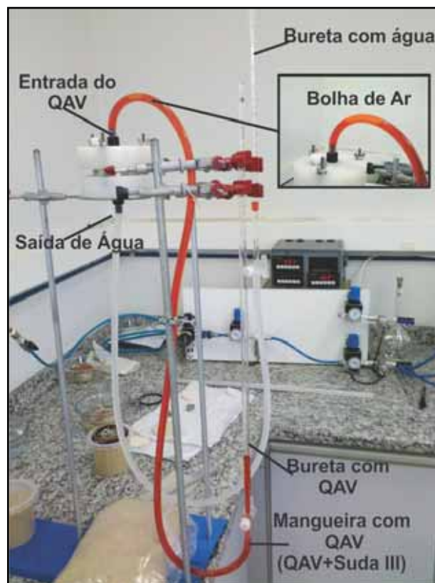
Figura 21 - Detalhe da segunda versão do equipamento para o teste do Sistema Água-Querosene e presença de bolha de ar.
