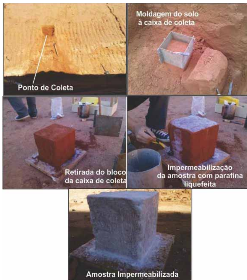
Foto 1 – Procedimento para a coleta do bloco de amostra indeformada
