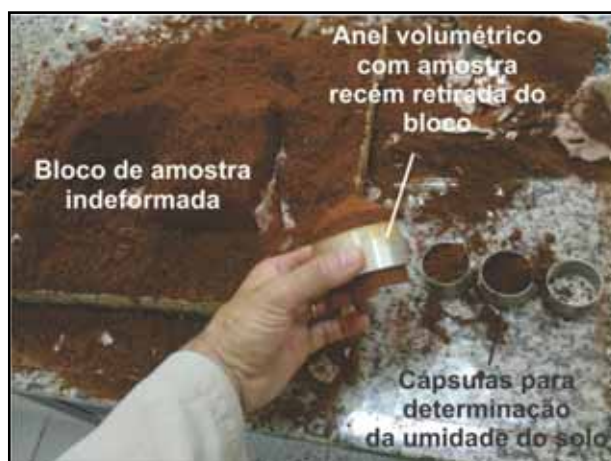
Figura 13 – Retirada de amostra indeformada e coleta de material para determinação de umidade do solo.
