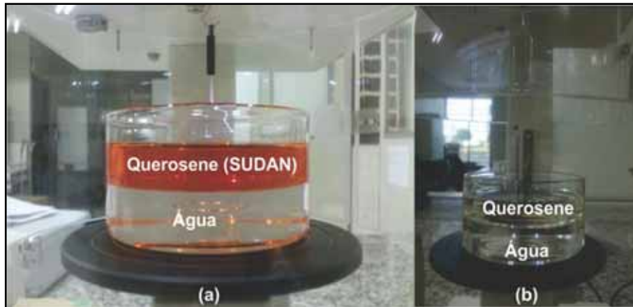
Figura 12 – Determinação da Tensão Interfacial (a) Determinação da tensão interfacial Querosene (SUDAN) e Água; (b) Determinação da tensão interfacial Querosene e Água
