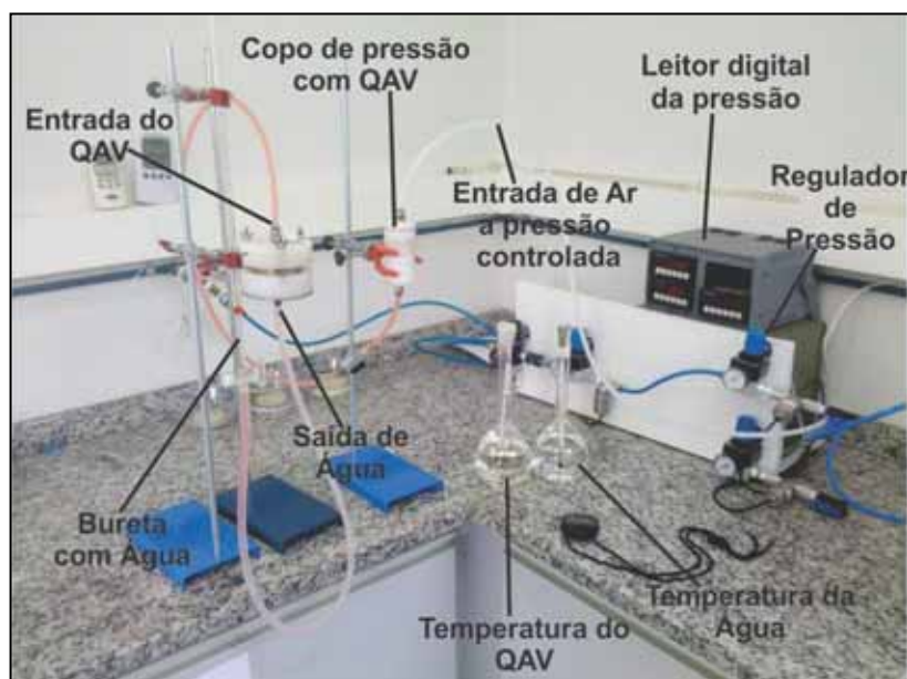
Figura 22 - Detalhe do equipamento para o teste do Sistema Água-Querosene, utilizando sistema de pressão controlada.
