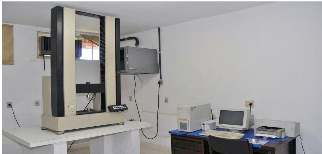
Figura 19 - Máquina universal de ensaios biomecânicos – EMIC
