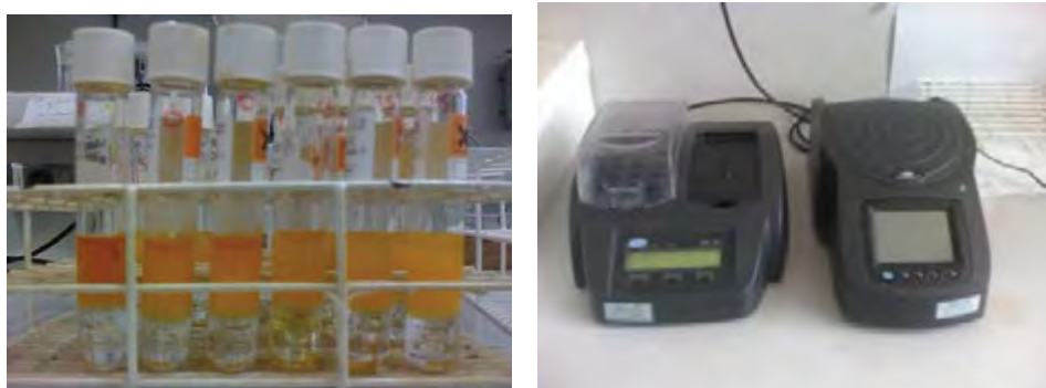
Figura 10: Tubos preparados para ir ao digestor (a esquerda), digestor e espectrofotômetro (a direita), respectivamente.
