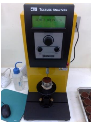
Apendice 25. Medição da resistência à penetração. Foto: arquivo pessoal.
