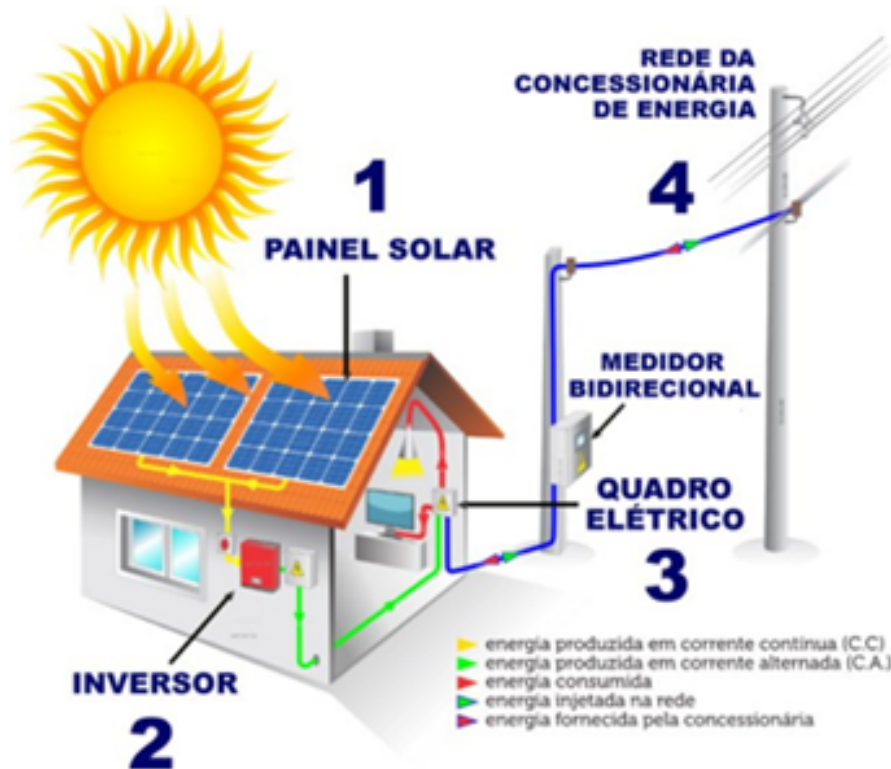
Figura 5 – Sistema fotovoltaico on-grid
