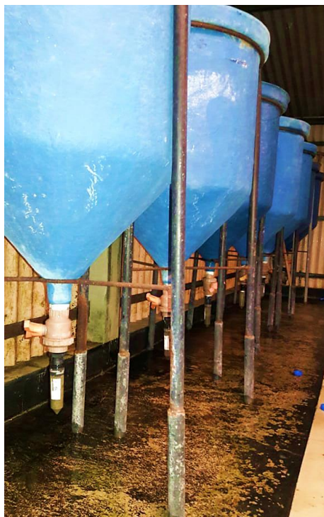
Figura 2 – Coletores tipo Guelph modificado
