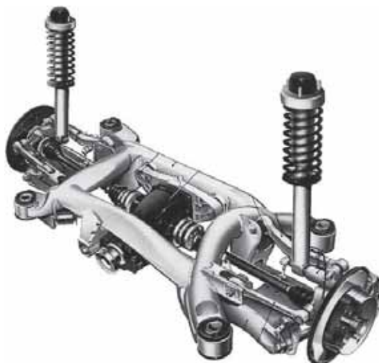
Figura 12 – Suspensão multi link usada na traseira do BMW Série 6 de 1996 (Reimpell, 2001)
