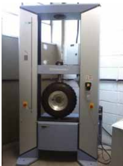
Figura 23 – Ensaio de rigidez de um pneu Maxxis modelo Maverick 21x7x10
