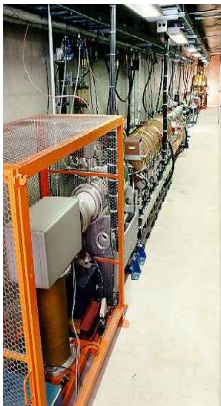
Figura 2.8- Acelerador Linear (LINAC) de elétrons localizado no LNLS - Campinas (adaptada do endereço eletrônico- http://www.lnls.br )
