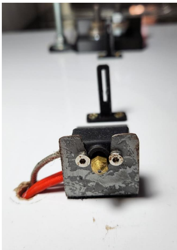
Figura 24 – Vista Frontal Módulo Aquecedor Construído
