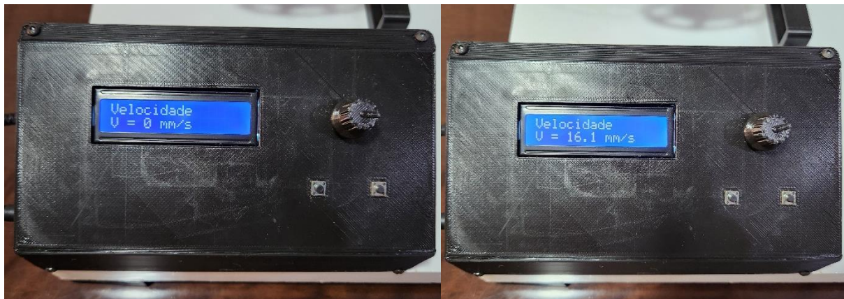
Figura 35 – Display Apresentado Informações da Velocidade
