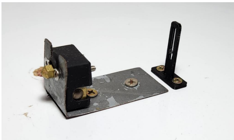
Figura 23 – Módulo Aquecedor Construído
