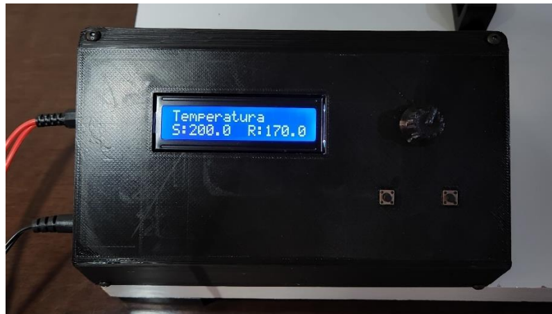
Figura 36 – Display Apresentado Informações da Temperatura
