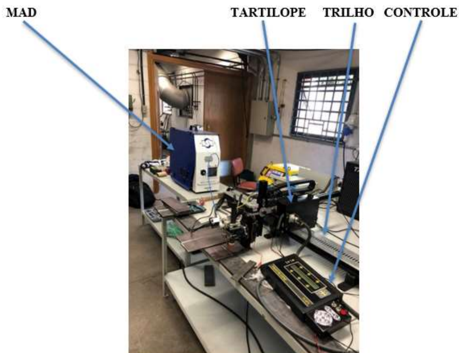
Figura 26 – Equipamentos Montados na Bancada de testes
