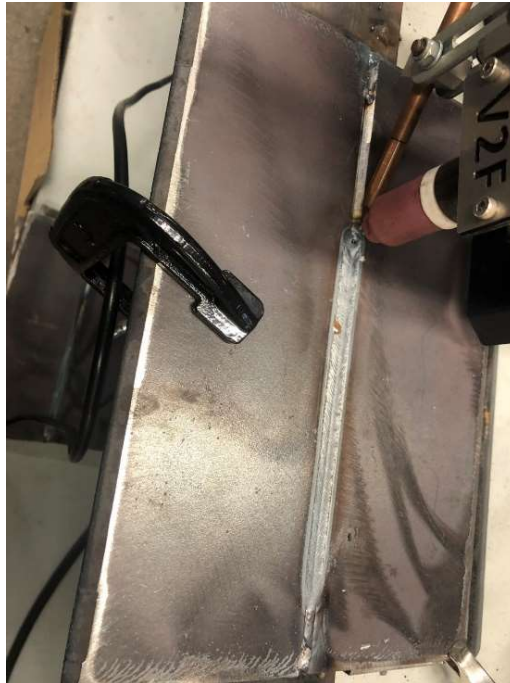
Figura 35 - Soldagem do primeiro passe com GTAW-DWF
