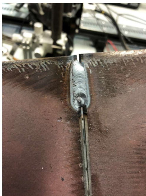
Figura 34 - Preparação para soldagem: Ponteamto com GTAW-DWF
