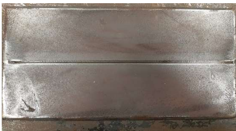
Figura 30 - Montagem da junta de topo com chanfro duplo V na preparação para soldagem com alimentação dinâmica no laboratório de soldagem da Fatec-SP
