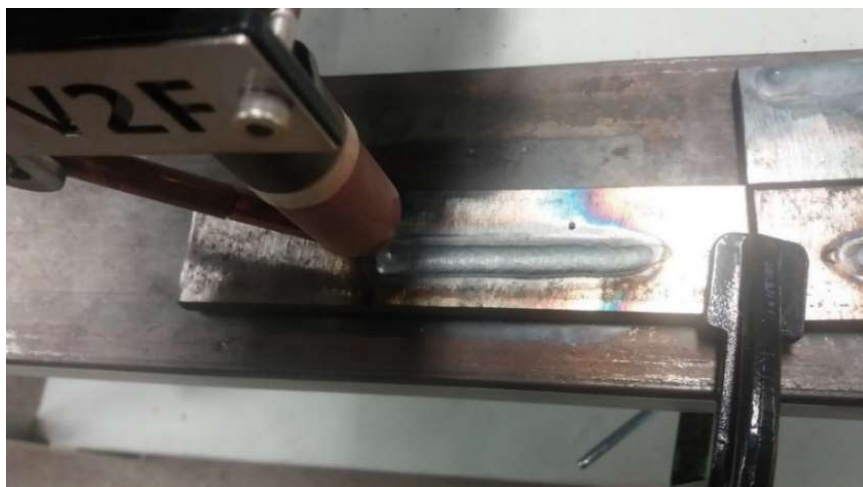
Figura 29 - Vista de topo do primeiro corpo de prova soldado com alimentação dinâmica no laboratório de soldagem da Fatec-SP
