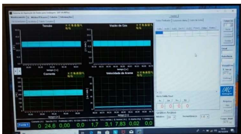
Figura 24- Tela do Sistema SAP para aquisição dos parâmetros de Soldagem em tempo real
