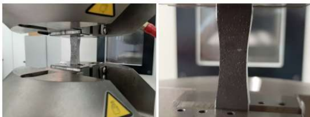
Figura 53 - Ensaio de fadiga axial no metal base “como laminado” na Instron 8801
