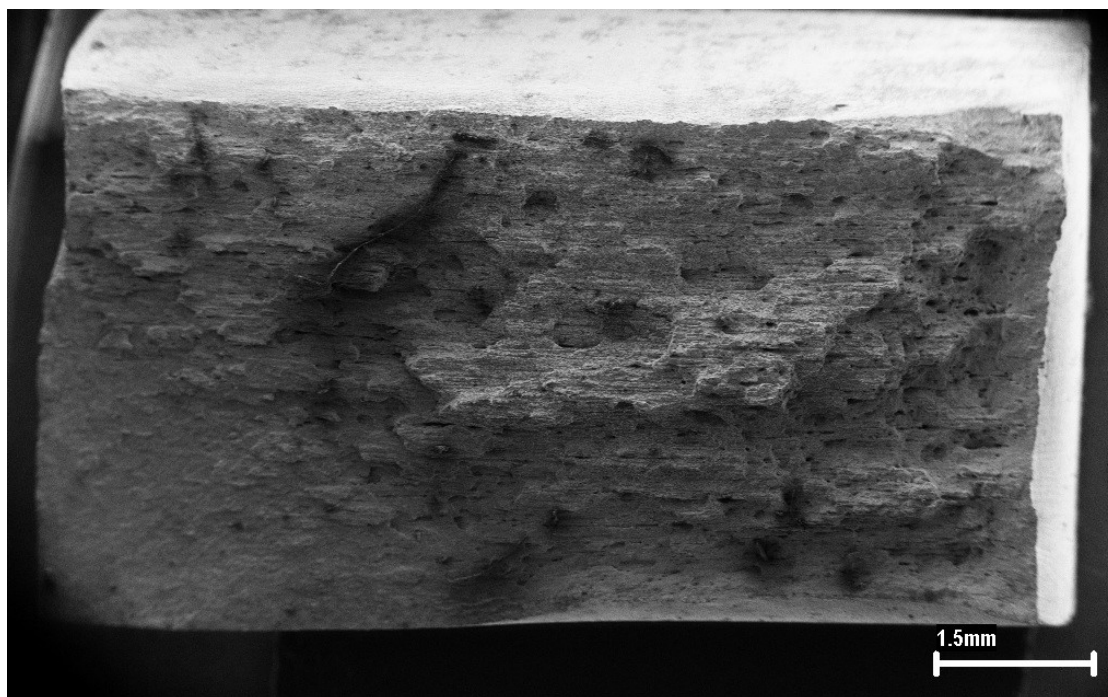
Figura 93 – Nucleação da trinca de fadiga nas bordas GTAW-DWF 10 Hz. MEV
