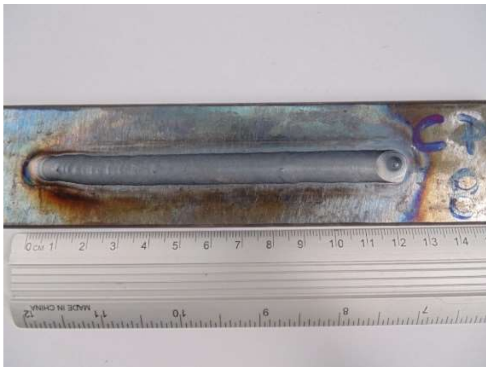
Figura 28- Amostra de deposição sobre chapa com alimentação dinâmica dos experimentos executados no Labsolda-UFSC
