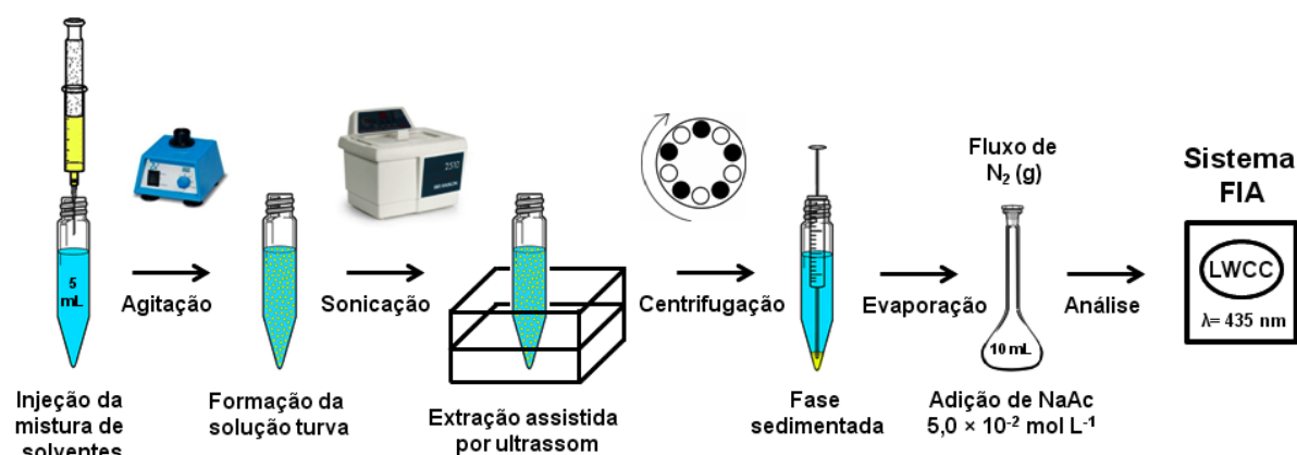
Figura 8. Esquema representativo do procedimento de microextração líquido-líquido dispersiva assistida por ultrassom (US-DLLME).
