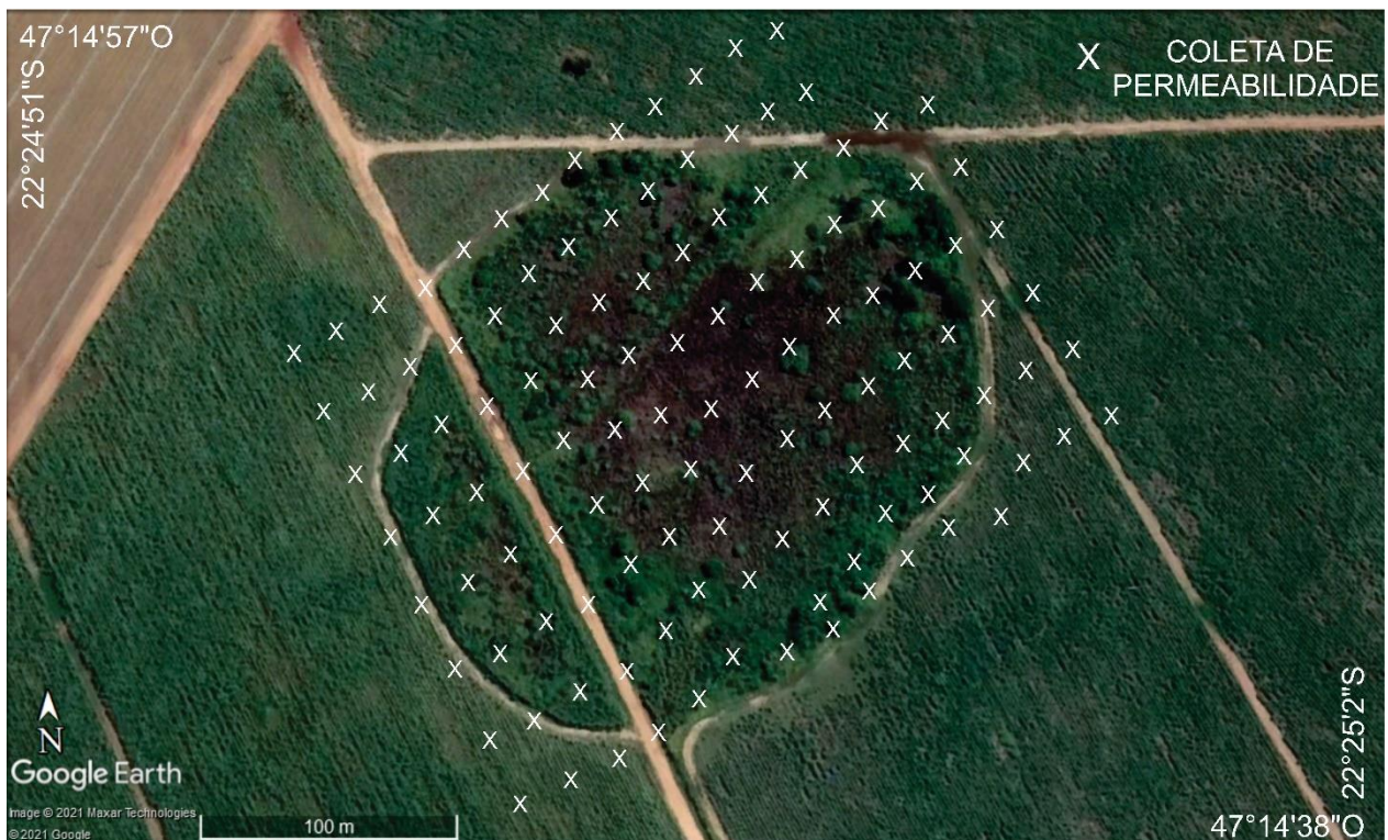
Figura 14: Malha de coleta de permeabilidade
