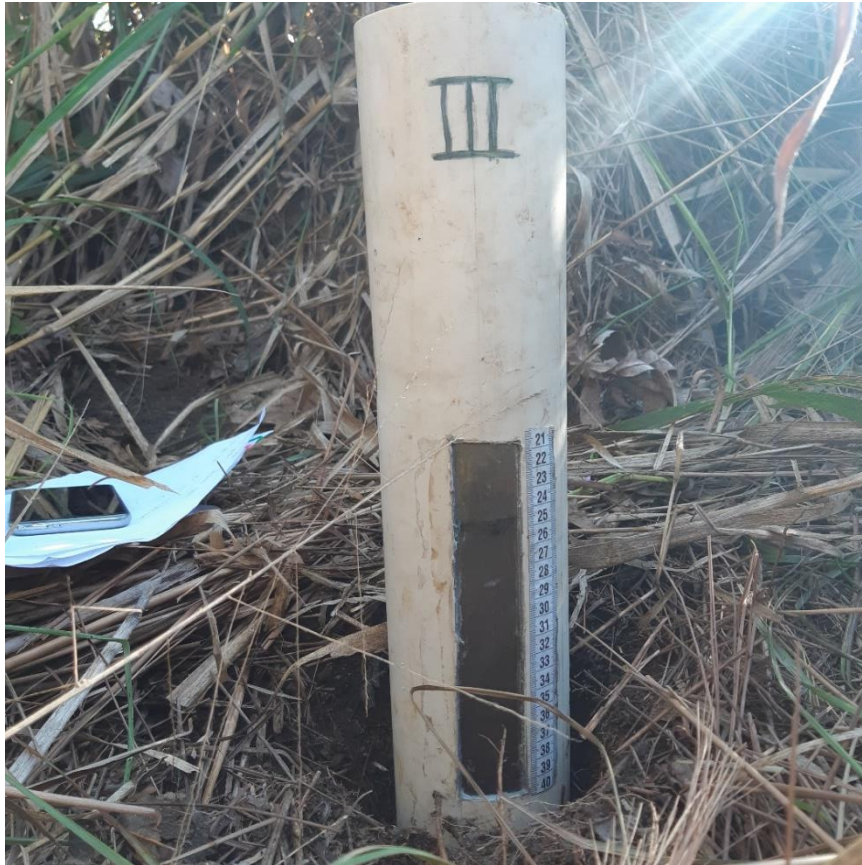
Figura 15: Fotografia do permeâmetro fixado ao solo e abastecido com água
