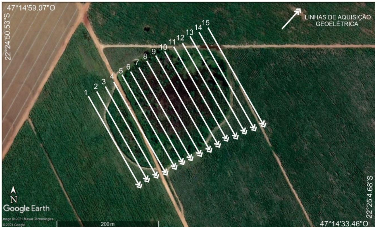
Figura 13: Malha de aquisição de dados geelétricos
