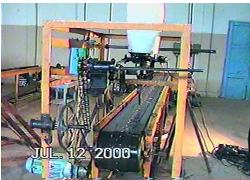
Figura 8 – Bancada de ensaio de semeadoras
