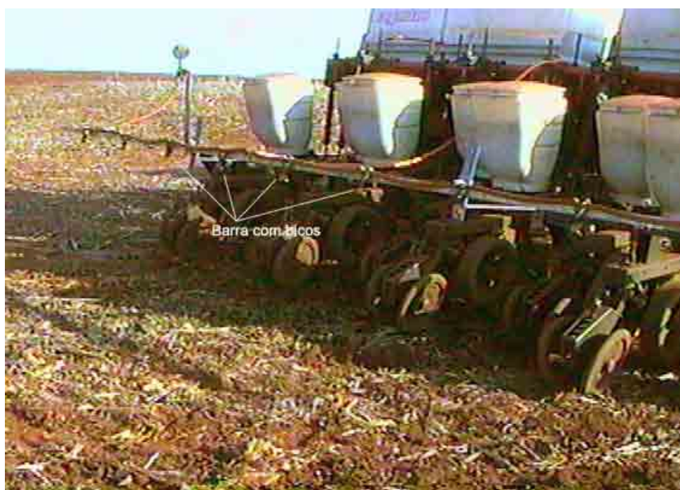
Figura 4 – Posicionamento posterior da barra de pulverização no protótipo pulverizador acoplado a semeadora-adubadora, em relação as rodas compactadoras.
