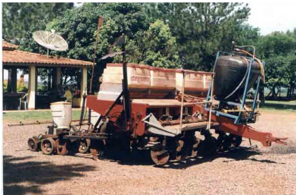
Figura 3 – Semeadora-adubadora com protótipo de pulverizador montado na parte anterior da máquina.
