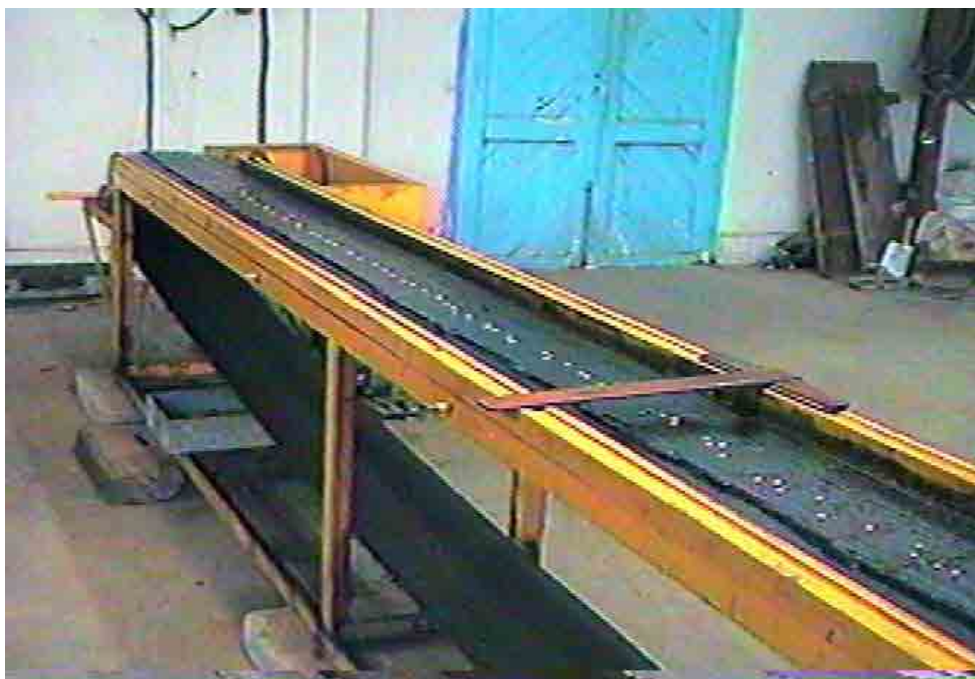
Figura 9 – Vista complementar da bancada de ensaio de semeadoras, observando-se as sementes aderentes à esteira untada com graxa.
