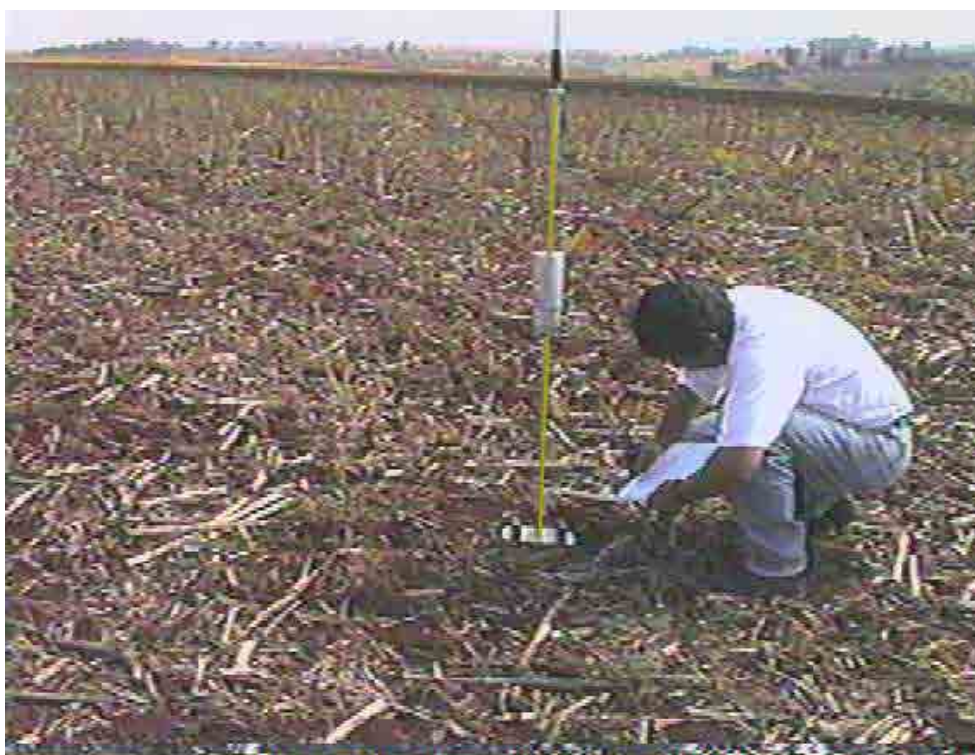
Figura 10 – Penetrômetro de impacto, usado para avaliação da resistência do solo à penetração na área experimental.
