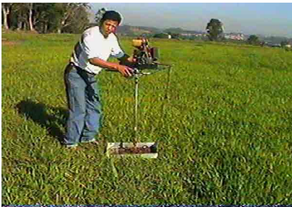
Figura 11 – Amostrador de solos motomecanizado.
