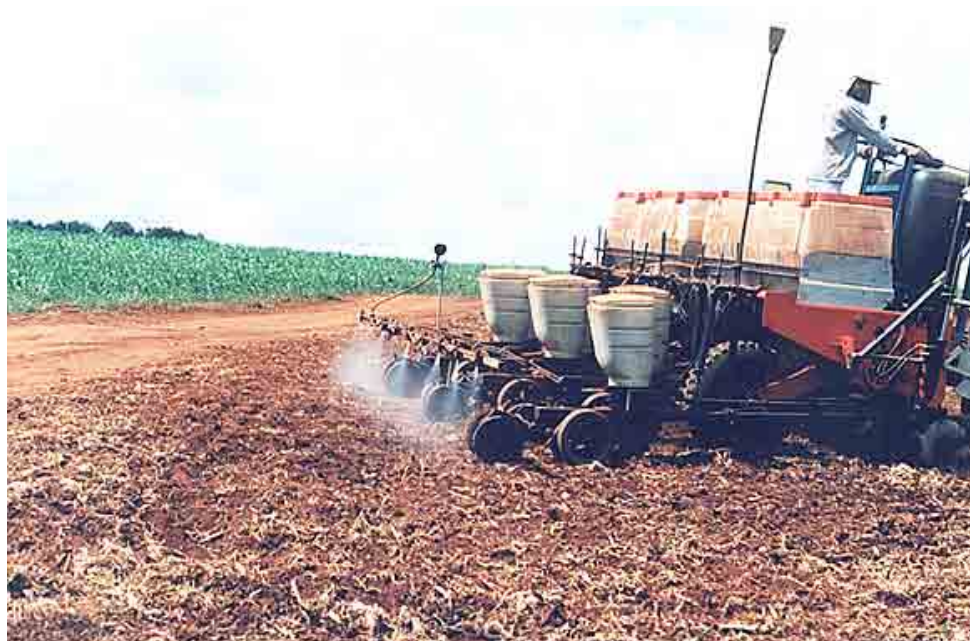
Figura 5 – Barra do pulverizador protótipo em operação.
