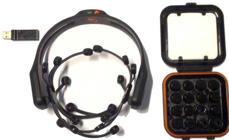
Figura 3.1: O dispositivo *Emotiv Epoc*. Da esquerda para a direita: pendrive para transferência de dados via *Wi-Fi*, *neuroheadset* com os eletrodos, recipiente para armazenagem dos eletrodos. Os eletrodos devem ser acoplados para uso e desacoplados e armazenados após uso para preservá-los. Um material esponjoso está presente na superfície de contato dos eletrodos que é utilizado para aplicação de uma solução salina para facilitar a condução de elétrons entre o eletrodo e o escalpo.
