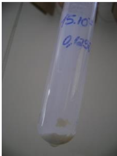
Figura 20 – Nanopartículas após banho de ultrassom.
