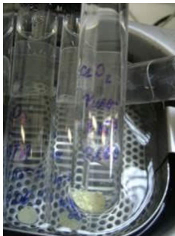
Figura 22 - Nanopartículas após banho de ultrassom.
