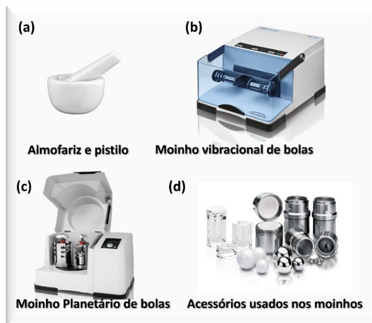
Figura 1.4. Aparatos usados para realizar sínteses mecanoquímicas: almofariz e pistilo (a), Moinho vibracional de bolas (b), Moinho planetário de bolas (c), e os acessórios usados nos moinhos (d).
