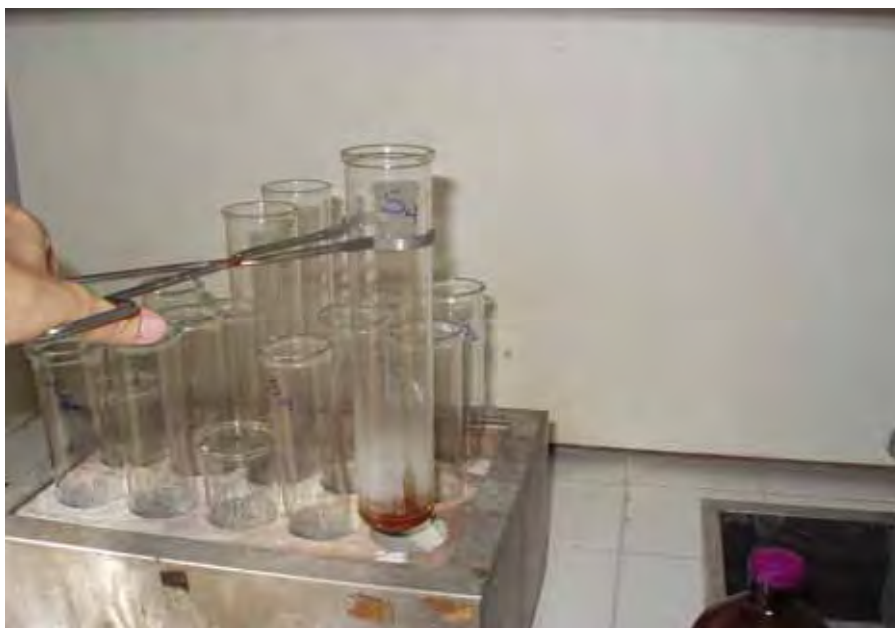
Figura 18: Amostra S 4 com ácido nítrico no bloco digestor
