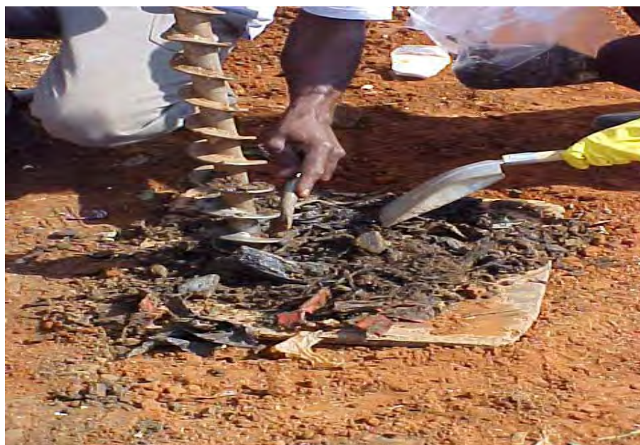
Figura 10: Retirada dos resíduos do trado mecânico
