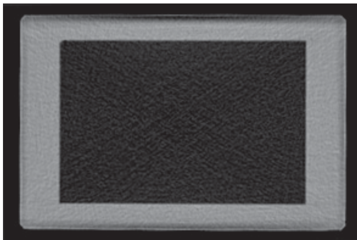
Figura 7: Corte axial tomográfico do fantoma de acrílico (externo) e água (interno) utilizado para calibração dos números de CT [30].
