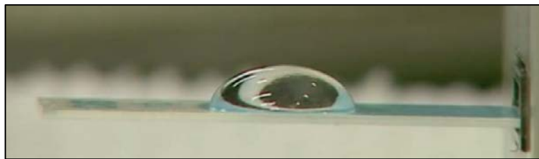
Figura 4. Eletrodos cobertos por 200 \mu L solução eletrolítica (PBS pH 7.4).
