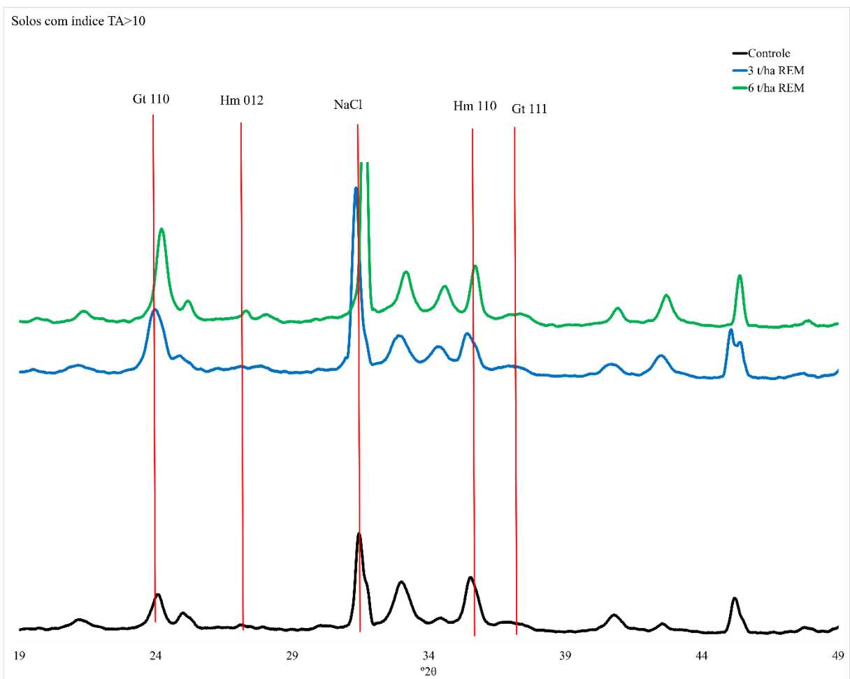
Figura 8 - DRX com foco na faixa de 2\theta entre 23^\circ e 49^\circ , evidenciando os picos dos óxidos de ferro em solo de Índice de TA > 10 tratado com REM.
