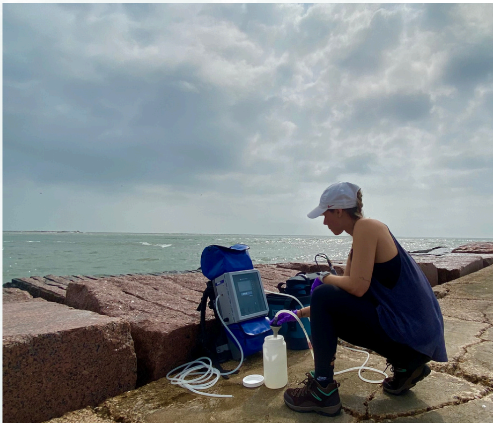
Figura 1. Coleta e filtração de amostras de água para análise de eDNA utilizando um amostrador de eDNA Smith-Root ( https://www.smith-root.com/edna/edna-sampler ). Créditos da imagem: Ingrid Bunholi e Mary Finch.
