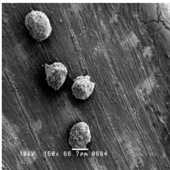
**Figura 24:** Pó comercial não triturado sinterizado a 1200°C, com ligante (2% de IBMA).
