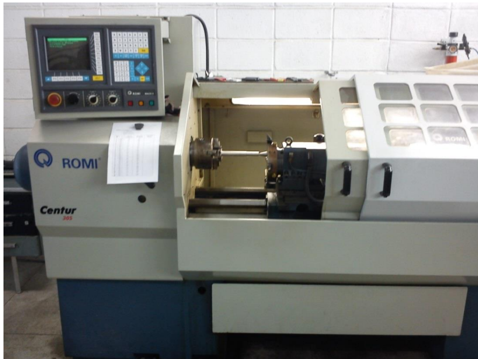
Figura 7 - Torno CNC Romi CENTUR 30S utilizado para a realização dos ensaios
