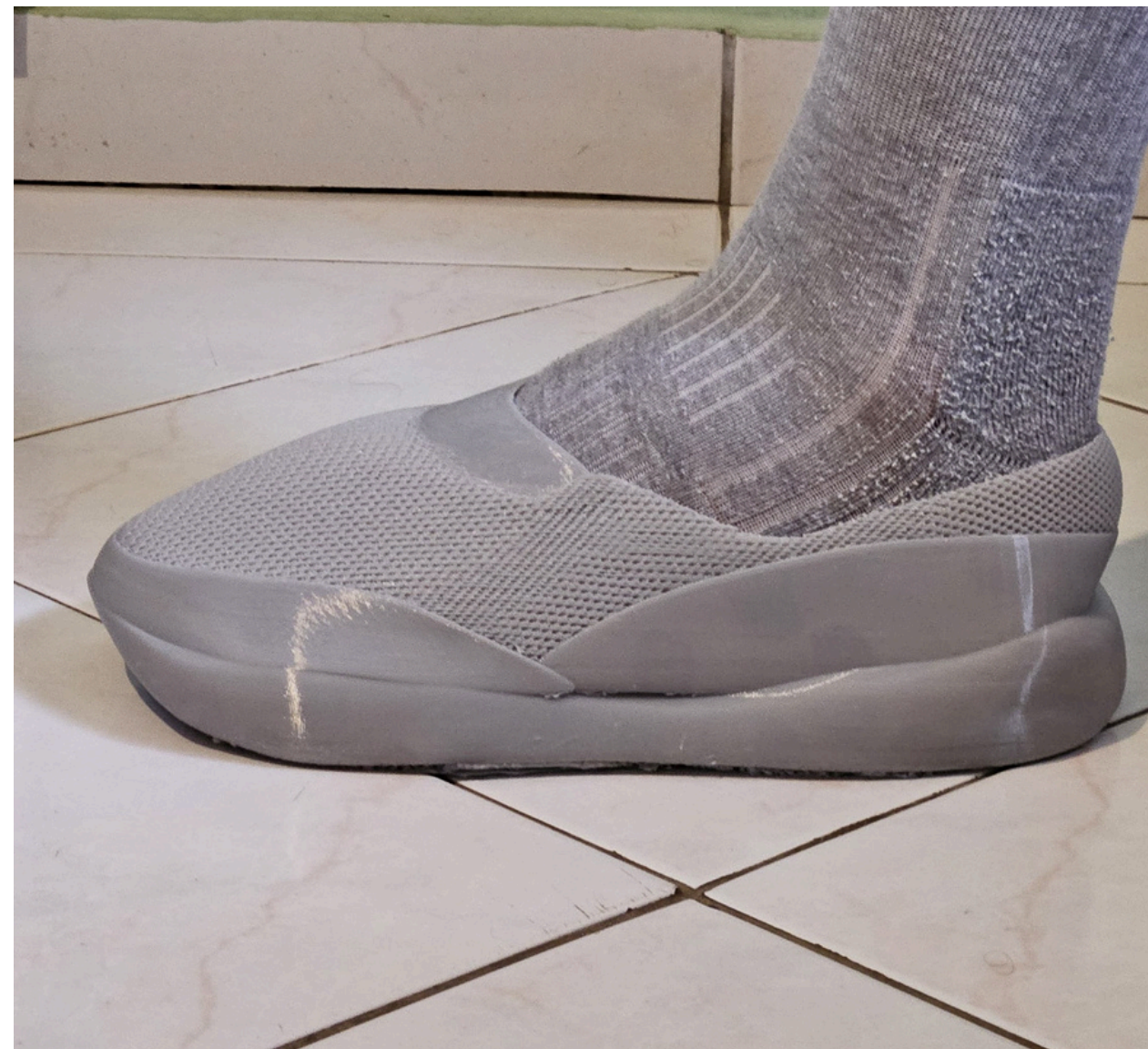
Figura 44: Protótipo impresso sendo usado pelo usuário, mesmo em um tamanho reduzido, coube, mas de forma apertada. Fonte: autor.
