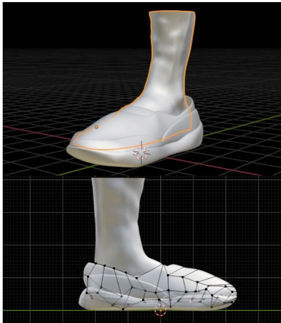
Figura 30: Viewport do Blender com o modelo após as alterações com base na anatomia do pé. Fonte: autor.
