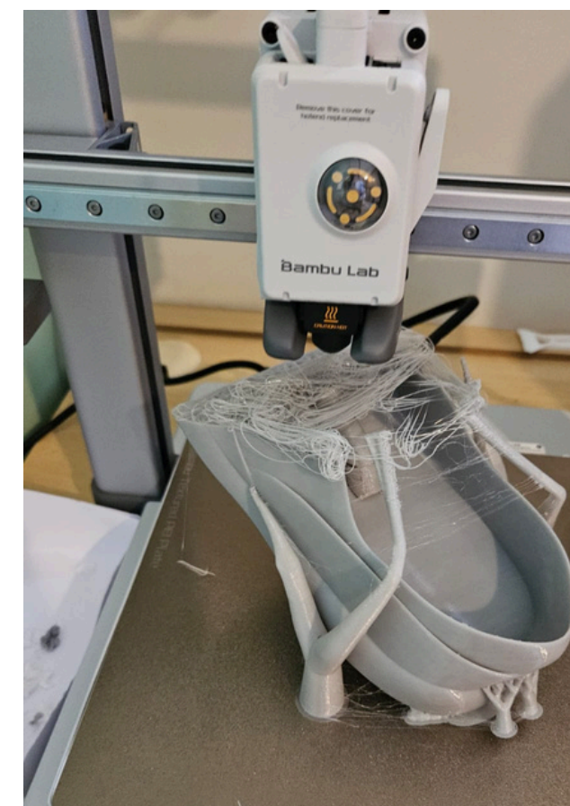
Figura 37: Primeiro protótipo sendo impresso em TPU, o mesmo apresentou falhas. Fonte: autor.
