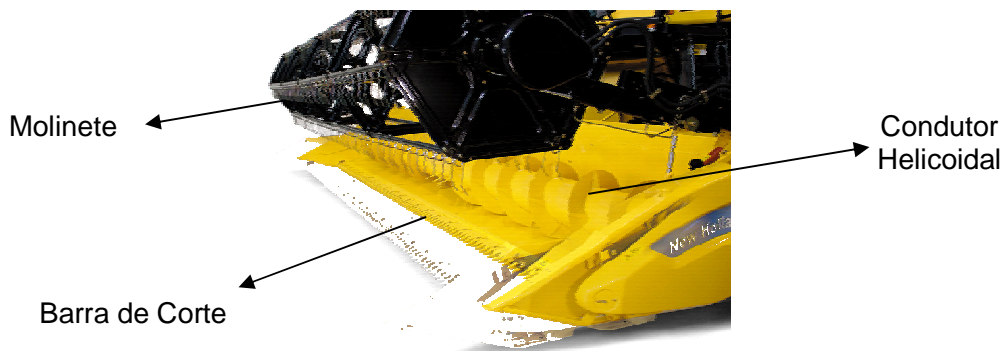
Figura 2. Plataforma e seus principais componentes.
