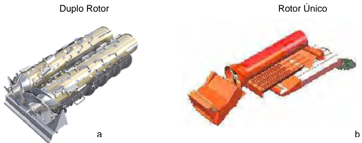
Figura 4. Sistema de trilha axial de duplo rotor (a) e rotor único (b).
