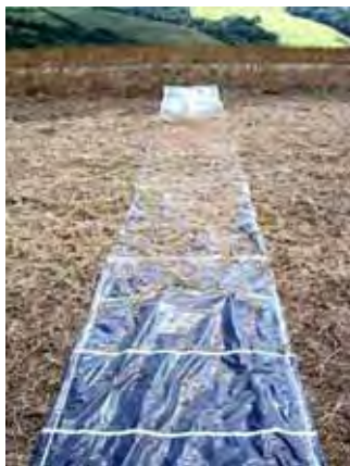
Figura 32. Detalhe do coletor utilizado para medição da distribuição da palha.
