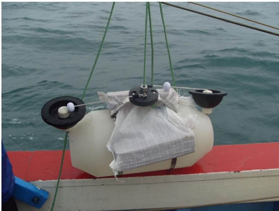
Figura 6: Garrafa de Van Dorn utilizada para coletar amostras de água. Fonte: Castilho, A. L., 2011.
