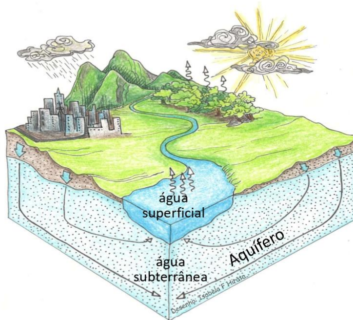
Figura 1. A água subterrânea é armazenada em aquíferos, que são grandes reservatórios situados no subsolo. A água subterrânea está em constante fluxo, de áreas mais elevadas para mais baixas. Nas regiões com chuvas mais abundantes (ex.: clima tropical) alimentam os cursos de água superficial (ex, rios) e constituem o seu fluxo de base.
