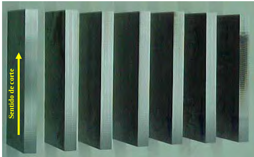
Figura 28 - Peças de aço ABNT 1045 de 1 a 6 e 9, da esquerda para direita, usinadas com Rebolo de CBN.
