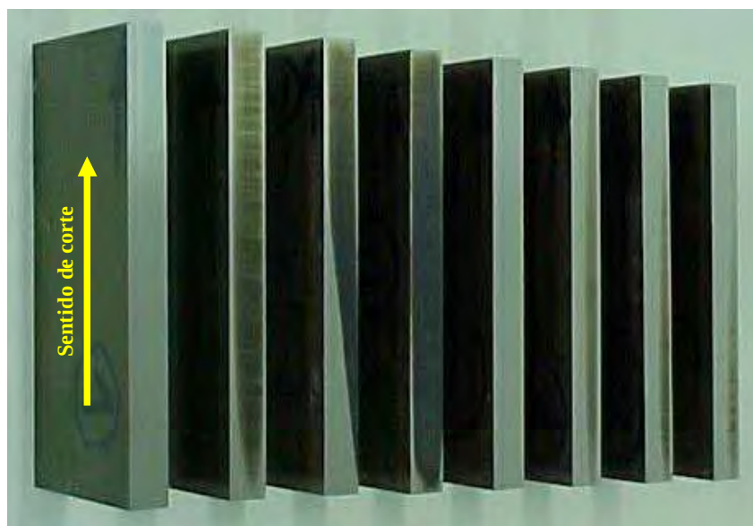
Figura 27 - Peças de aço VC131 de 1 a 8, da esquerda para direita, usinadas com Rebolo de Óxido de Alumínio.
