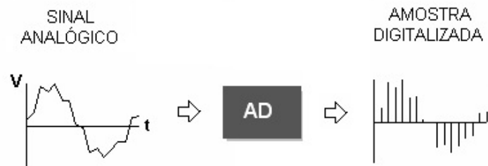
Figura 18 - Conversão de um sinal analógico em digital (Proakis; Manolakis, 1996 – adaptado)
