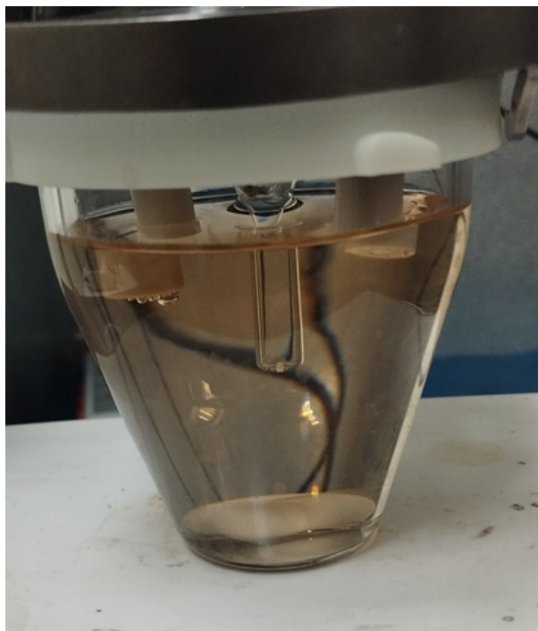
Figura 14 – Célula eletroquímica de eletro-oxidação de dopamina após o processo de voltametria cíclica.
