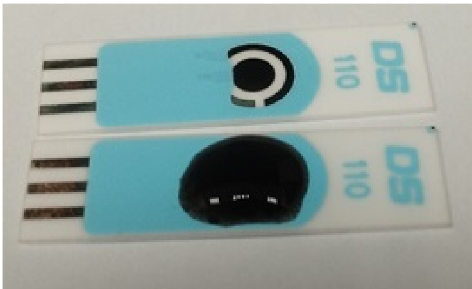
Figura 12 – Exemplificação do processo de acompanhamento utilizando microeletrodos de carbono, com superfície seca acima e e contato com a solução de dopamina abaixo.
