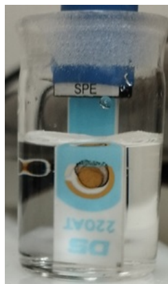
Figura 15 – Representação do processo da célula eletroquímica utilizada para as medidas de voltametria cíclica e espectroscopia de impedância eletroquímica.
