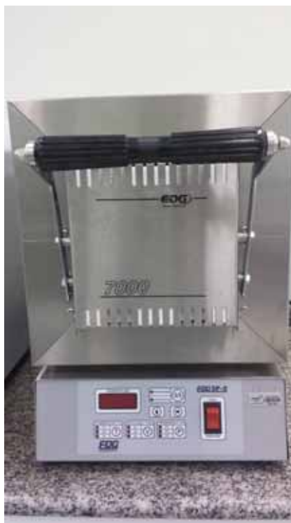
Figura 9 - Forno utilizado para tratamento térmico
