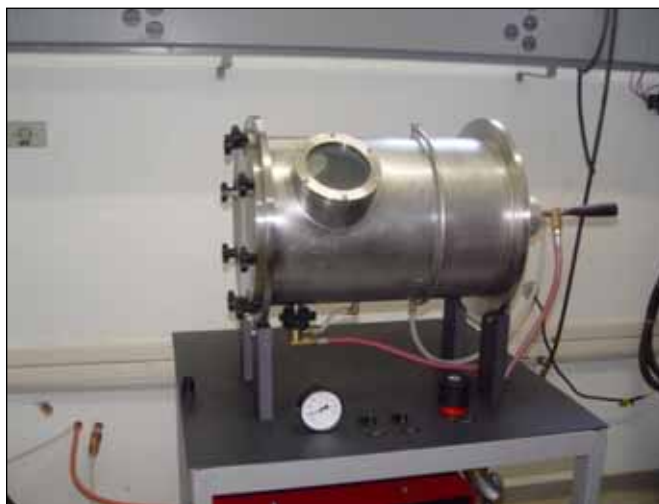
Figura 5 – Forno a arco voltaico utilizado para obtenção das ligas
