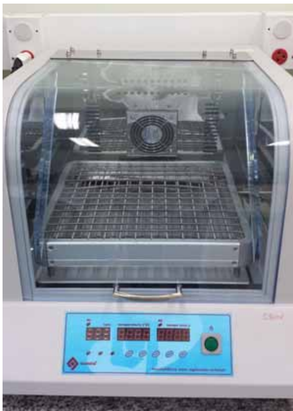
Figura 11 - Mesa agitadora utilizada no procedimento de imersão em SBF
