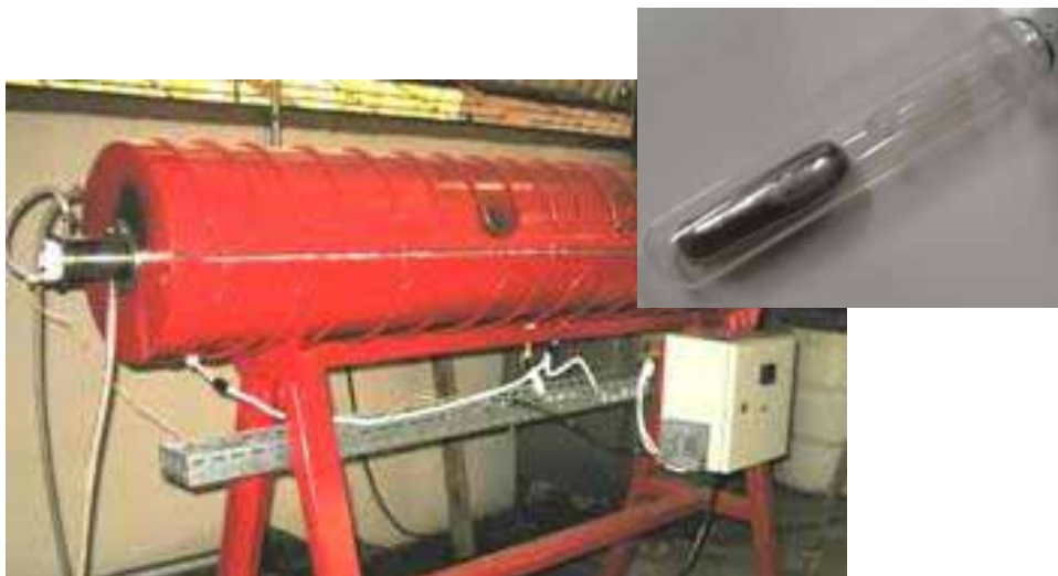
Figura 6 - Forno tubular empregado para homogeneização das ligas. Detalhe do lingote encapsulado
