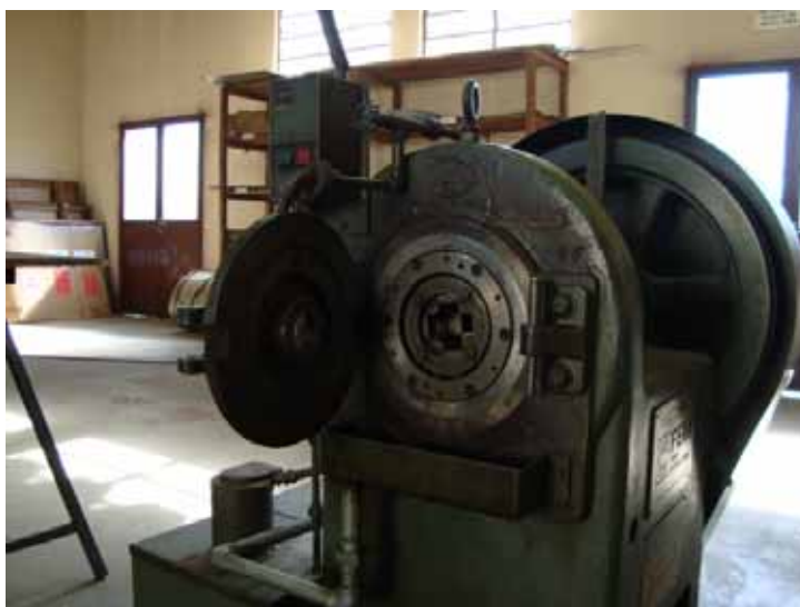
Figura 7 - Equipamento para forjamento à frio FENN e os martelos
