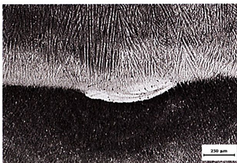
Figura 4.12 – Região central do cordão de solda TIG mostrando região dendrítica para ZF
