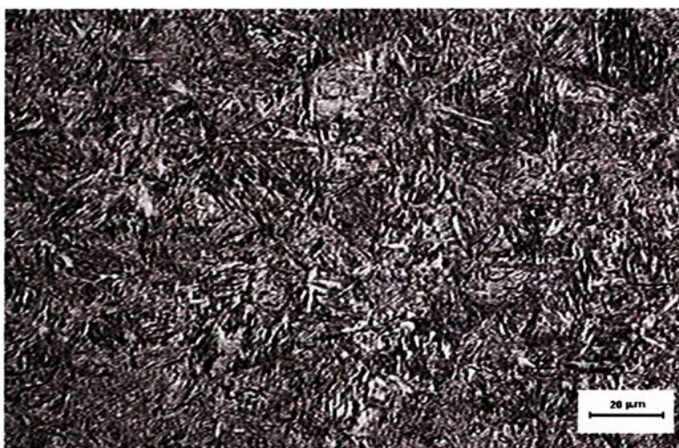
Figura 4.21 – Região MB mostrando uma microestrutura martensítica para condição soldada a plasma
