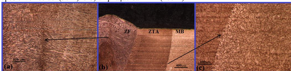
Figura 19 - A) Ampliação do centro da solda (200 X), B) região de solda do aço Maraging após envelhecido (50 X) e C) ampliação da ZTA (200 X)
