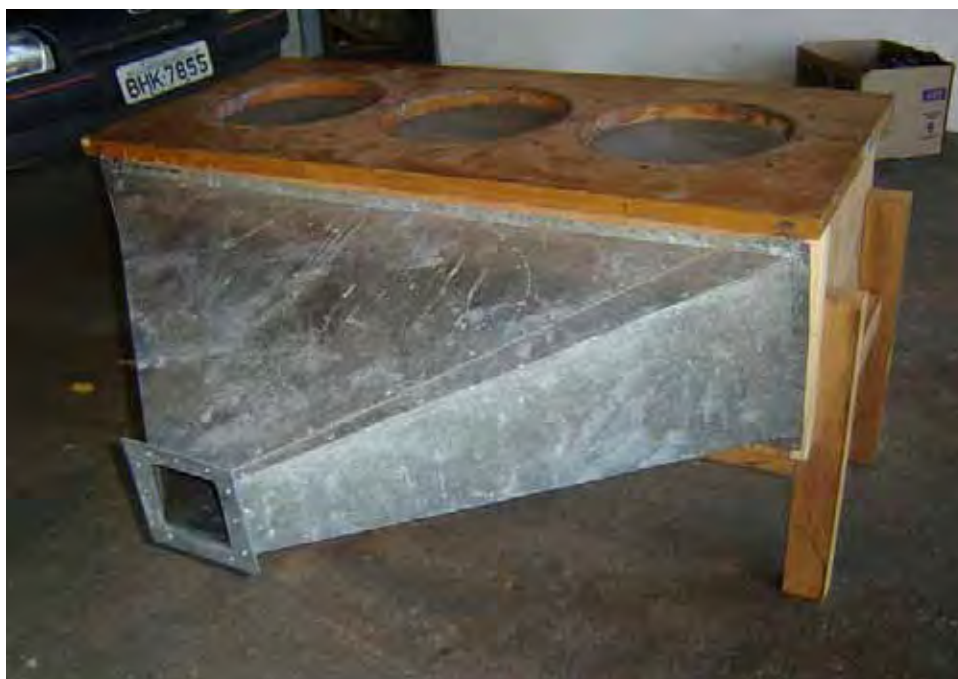
Figura 06. Esquema do protótipo, setor inferior, utilizado na secagem de Baixa temperatura, mostrando divergente em ângulo de 45^\circ
