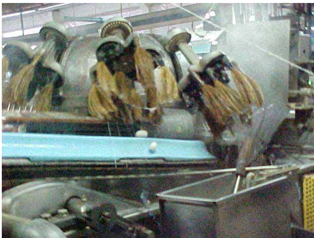
Figura 2. Detalhe da escupinadeira utilizada para encontrar o fio de seda
