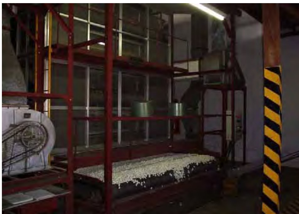
Figura 09. Secador convencional, imagem frontal do secador, utilizado pela Bratac, modelo YAMATO.
