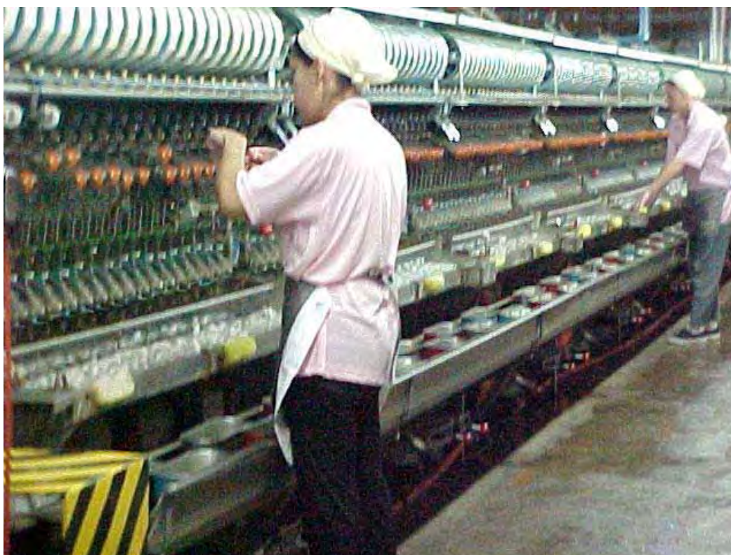
Figura 3. Detalhe da fiandeira utilizada no processo de desenrolamento
