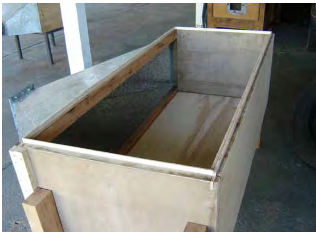
Figura 5. Esquema do protótipo, parte interior, utilizado na secagem de baixa temperatura, mostrando a câmara plenum.
