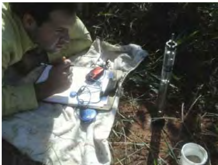
Figura 18 - Infiltração de água no solo utilizando o mini infiltrômetro de disco, Selvíria, MS. 2011.
