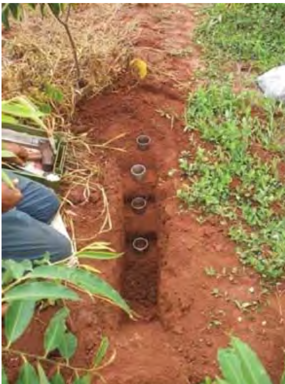
Figura 15- Coleta das amostras indeformadas com anel volumétrico, na área experimental Selvíria, MS.2011.
