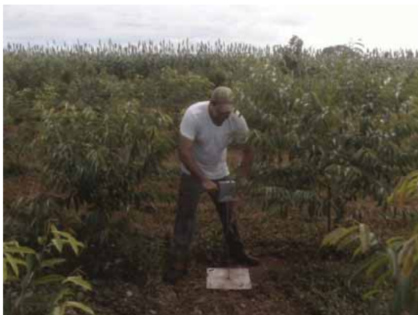
Figura 19 - Teste de resistência do solo à penetração com o aparelho PenetroLog, Selvíria, MS. 2011.
