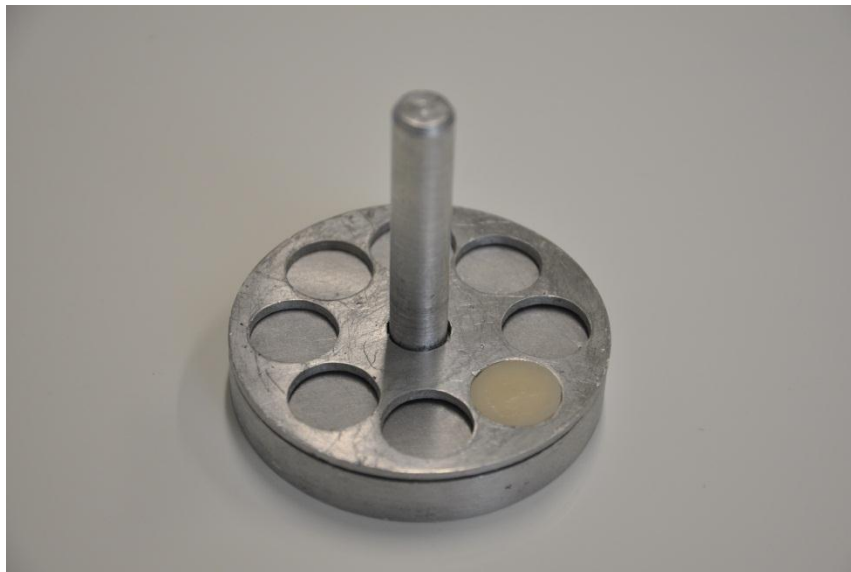
Figura 1 – Matriz metálica circular com amostra de resina
