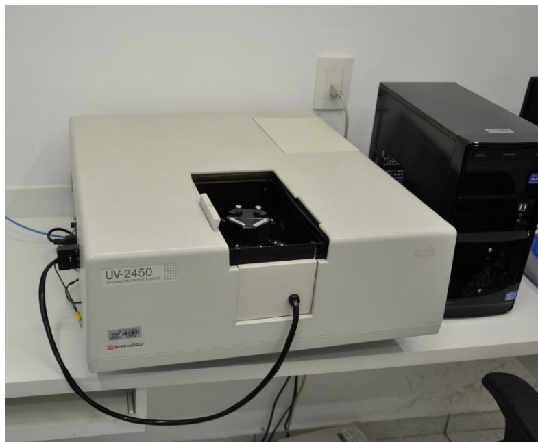
Figura 3 - Espectrofotômetro de Reflexão Ultravioleta Visível, Modelo UV-2450 – Shimadzu
