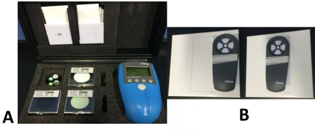
Figura 19- Em “A” - Espectrofotômetro de Colorimetria (Color guide 45/0, PCB 6807 BYK-Gardner GmbH, Geretsried, Alemanha) e em “B”, aparato auxiliar para padronização do posicionamento dos cps e realização das medidas de cor.
