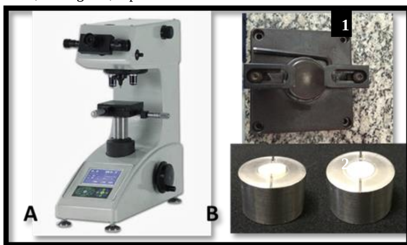
Figura 21- Em “A” – Microdurômetro. Em “B1”, dispositivo utilizado para acoplar a matriz metálica no microdurômetro e em “B2” ranhura no cp evidenciada com grafite coincidindo com a ranhura da matriz e, em seguida, espécime inserido na matriz.
